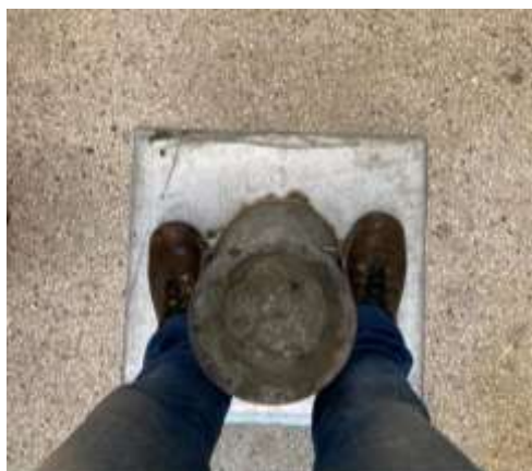
Figura 3 - Ensaio de Abatimento.
