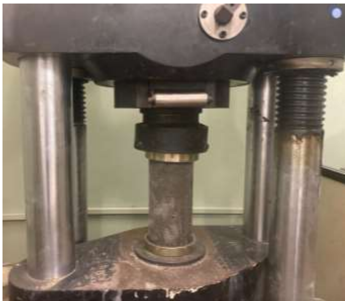
Figura 6 - Corpo de Prova Posicionado na Prensa Hidráulica.
