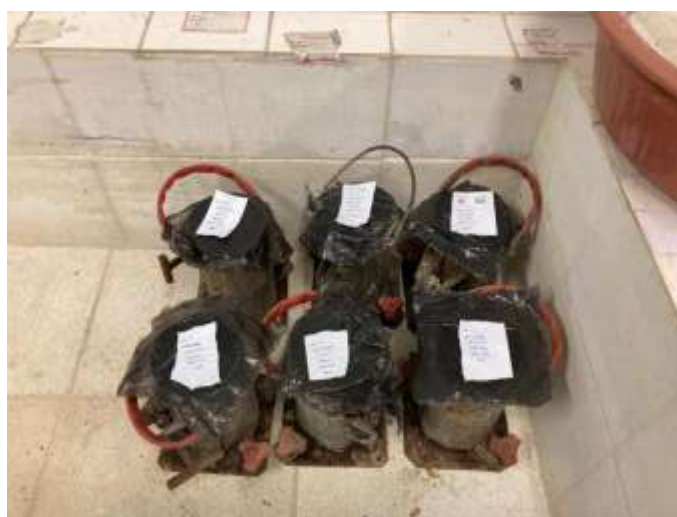
Figura 4 - Concreto Moldado em processo de Secagem.
