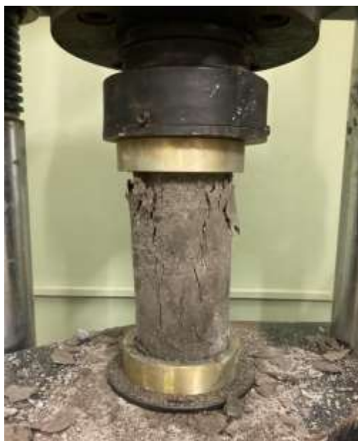
Figura 7 - Corpo de Prova Após o Rompimento.
