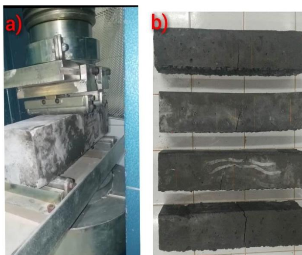
Figura 9 – Ensaio de resistência à flexão, a) Amostra na prensa hidráulica; b) amostras após rompimento (A autora, 2023).
