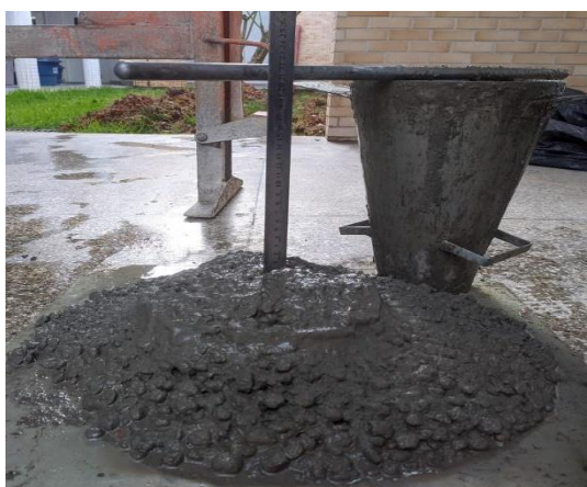
Figura 5 – Medição do abatimento (A autora, 2023).
