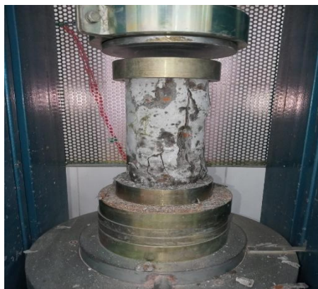
Figura 8 – Ensaio de resistência à compressão do concreto leve (A autora, 2023).
