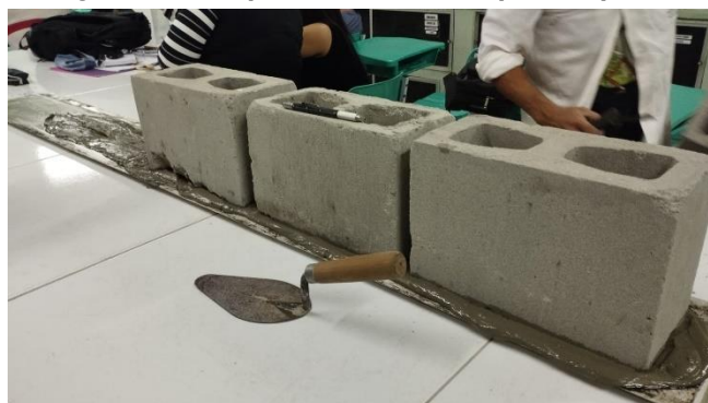
Figura 16 – Capeamento dos corpos de prova
