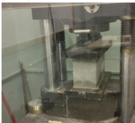
Foto 11 - – Corpo de prova durante ensaio de compressão axial
