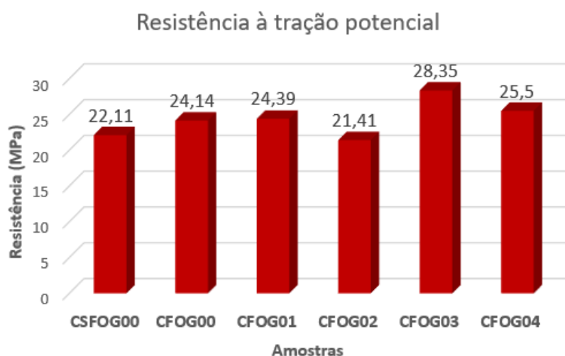
Figura 20 – Resultados das resistências à tração potenciais dos corpos de prova de cada traço
