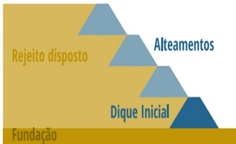
Figura 1 - Corte esquemático do método de alteamento à montante
