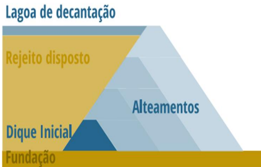
Figura 2 - Corte esquemático do método de alteamento à jusante
