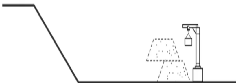
Figura 6 - Remoção dos diques de rejeitos
