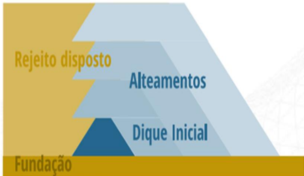
Figura 3 - Corte esquemático do método de alteamento de linha central
