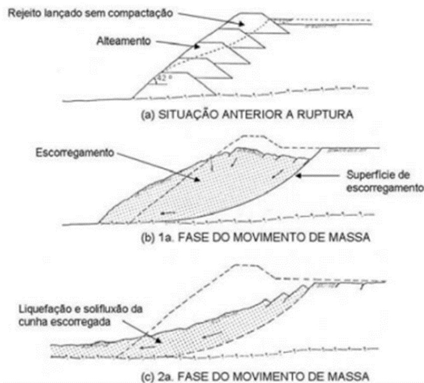
Figura 20 - Fases da ruptura da Mina de Fernandinho
