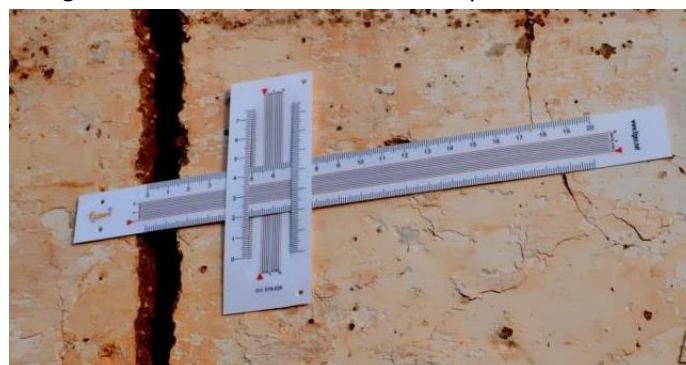
Figura 22 – Brecha com abertura superior a 10,0 mm
