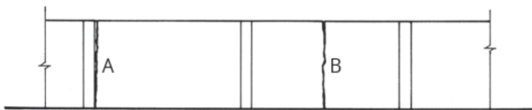
Figura 5 – Fissuras geométricas ou isoladas
