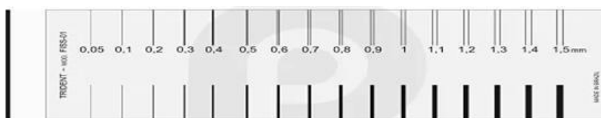
Figura 19 – Fissurômetro encontrado no mercado
