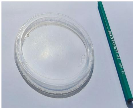
**Figura 1.** Forma utilizada para preparação dos corpos de prova (Fonte: Autor).
