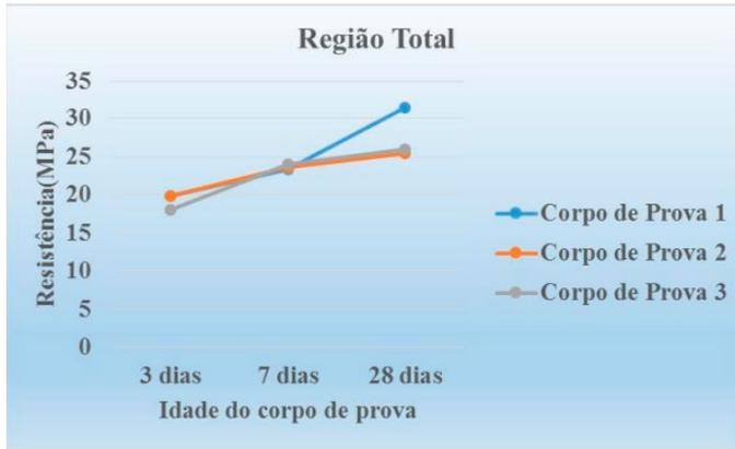
**Figura 4.** Gráfico de resistência x tempo para toda a região.
