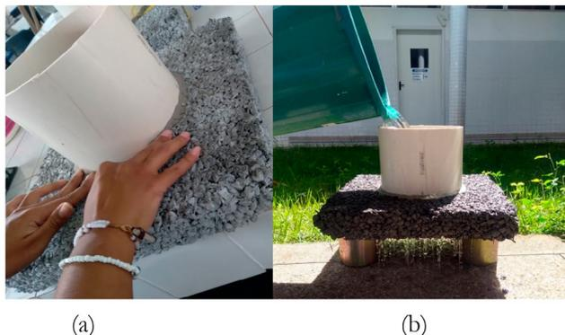
**Figura 1.** Processo do ensaio de permeabilidade (a) Preparação da placa para o ensaio de permeabilidade. b) Processo de molhagem do corpo de prova (Fonte: Autor).
