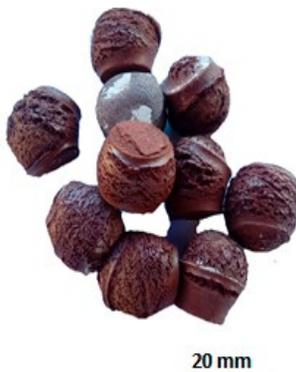
**Figura 10.** Foto do agregado leve produzido (Fonte: Autor).
