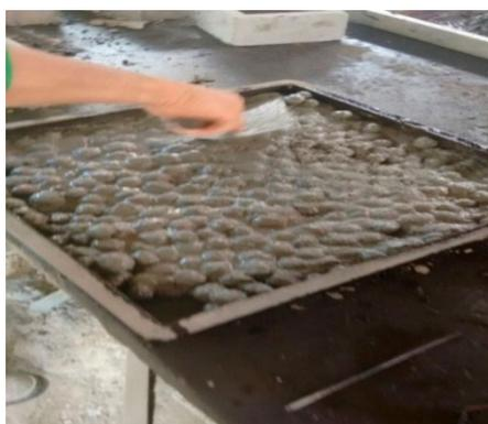
**Figura 7.** Placas de concreto produzido com argila expandida.
