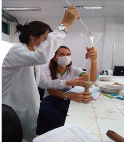
**Figura 1.** Determinação da massa específica real da areia (Fonte: dados da pesquisa).
