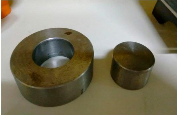
**Figura 1.** Anilhas de aço utilizadas para rompimento dos corpos de prova.
