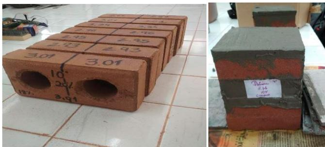
**Figura 1.** Preparação dos tijolos para o ensaio de resistência à compressão (Fonte: Autor).
