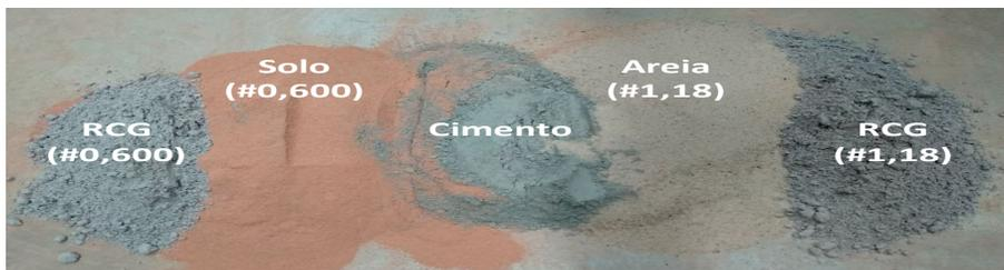
**Figura 1.** Materiais utilizados na produção dos tijolos (Fonte: Autor).
