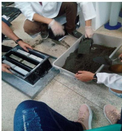
**Figura 2.** Fôrma para confecção dos blocos de concreto (Fonte: dados da pesquisa).
