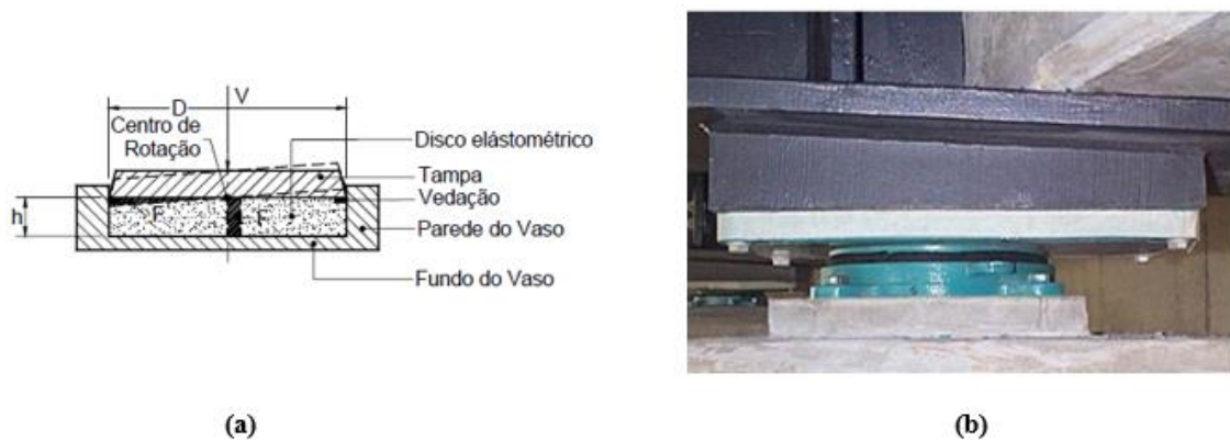
Figura 14 – (a) Aparelho de apoio de elastômero contido ( Pot-Bearings ) em corte, (b) Imagem do aparelho de apoio Pot-Bearings sendo utilizado
