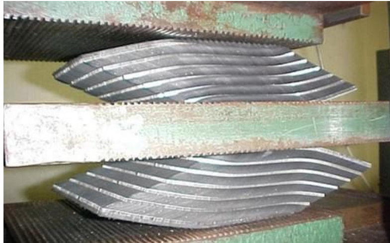
Figura 12 – Ensaio de distorção em aparelho de apoio de elastômero
