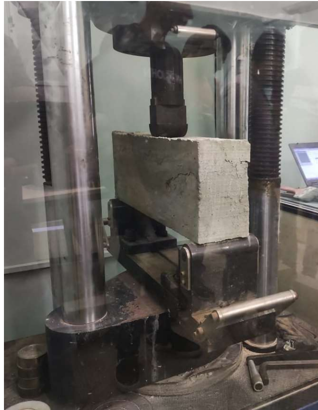
Figura 27: Pré-fissuração dos protótipos de vigas.
