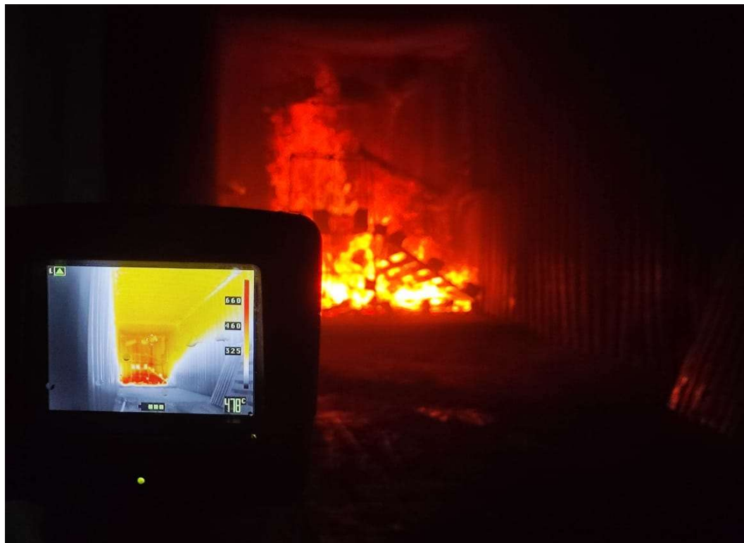
Figura 42: Fase de elevação da temperatura monitorada através de câmera térmica.
