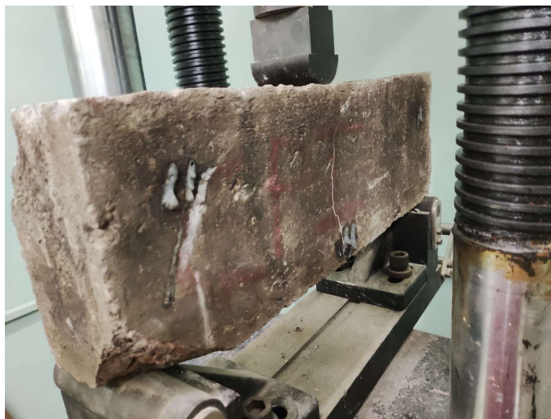
Figura 46: Protótipo sendo submetido a ensaio de flexão.
