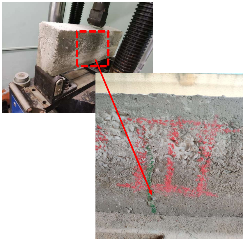
Figura 29: Pré-dano no protótipo de viga CIII.
