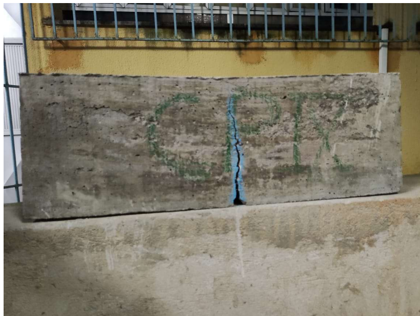
Figura 47: Protótipo de viga rompido a flexão.
