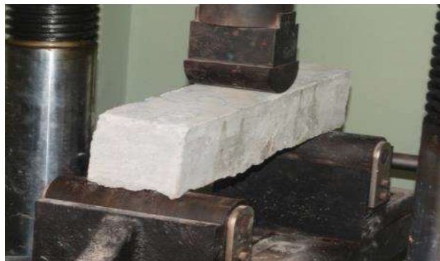
Figura 15: Ensaio de flexão em 3 pontos.
