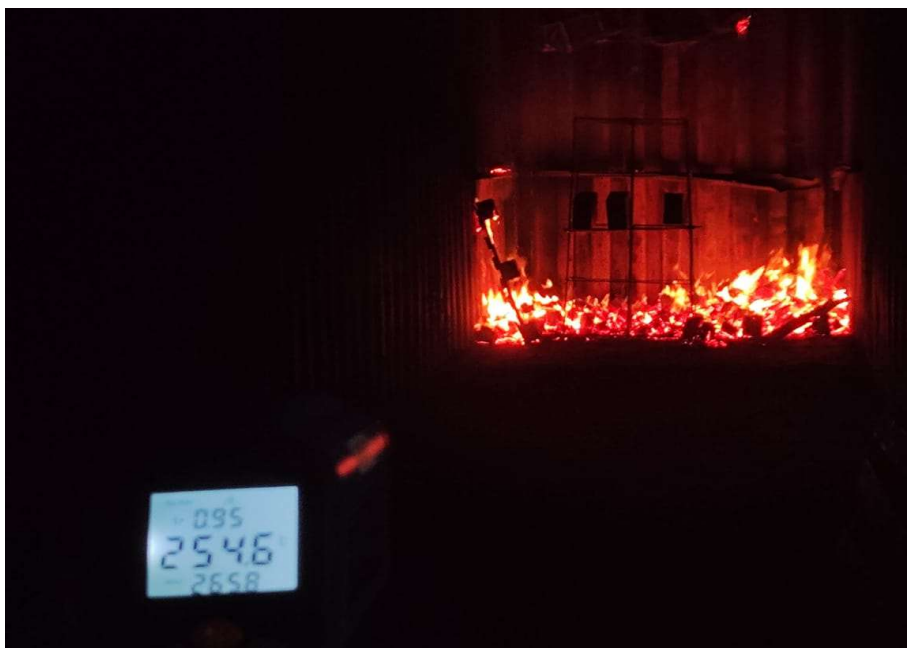
Figura 43: Fase de declínio monitorada através de pirômetro.
