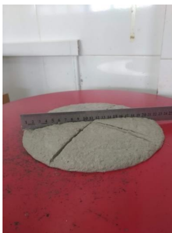
Figura 5 - Medição do espalhamento da argamassa (A autora, 2023).
