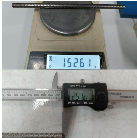
Figura 7 - Medições do peso e comprimento da barra inicial
