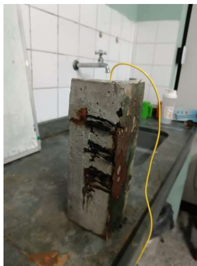
Figura 15 - Corpo de prova submetido ao ensaio de CAIM por 48 horas
