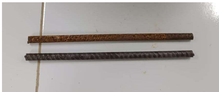
Figura 6 - Limpeza das barras
