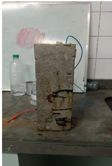
Figura 14 - Corpo de prova submetido ao ensaio de CAIM por 24 horas
