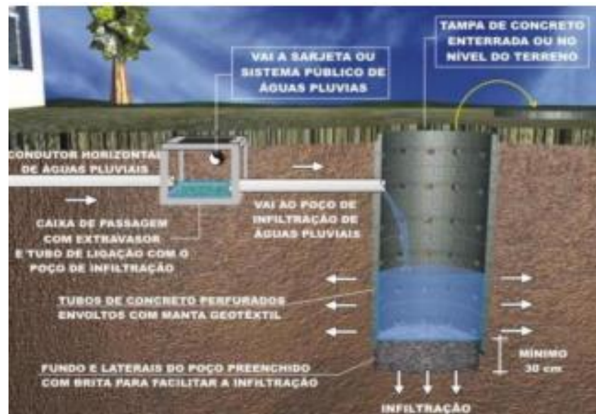
Figura 20: Corte do Poço de Infiltração
