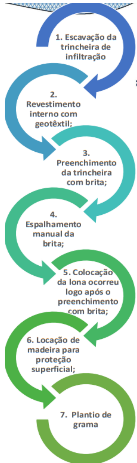
Figura 22: Trincheira de Infiltração
