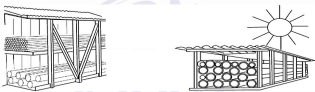
Figura 17 - Exemplos de estocagem de tubos
