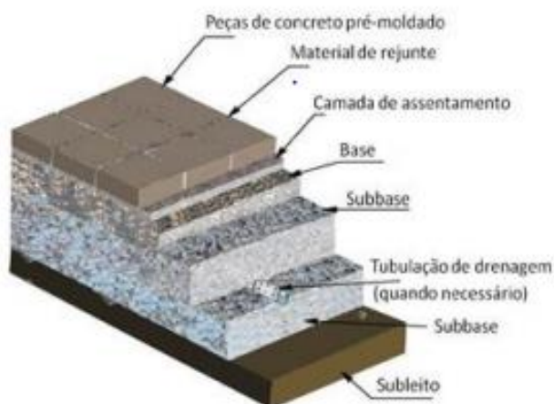
Figura 20 - Esquema de Pavimentação de Paralelepípedo
