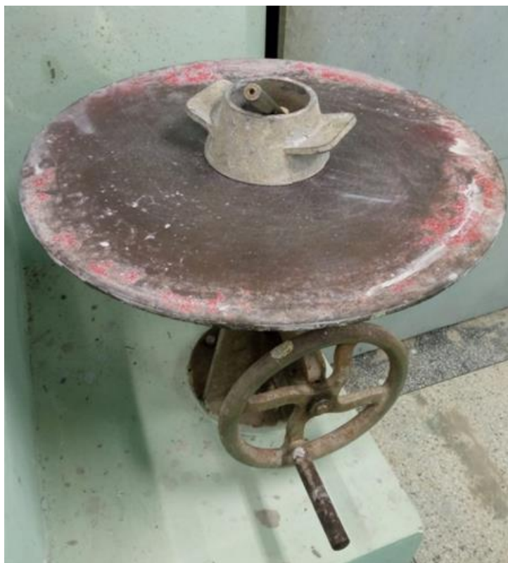
Figura 17: mesa de consistência ( flow table )
