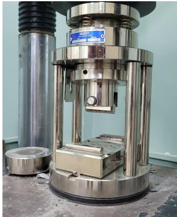
Figura 19: Prensa com apoio para ensaio de tração na flexão.
