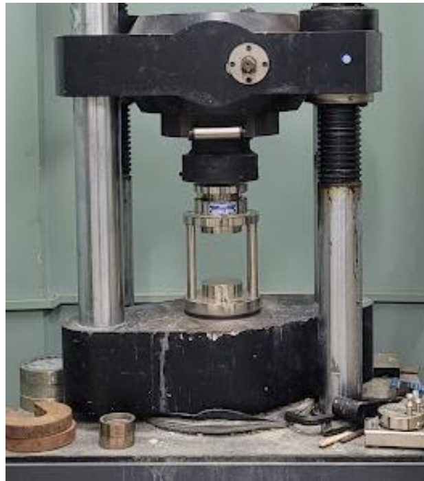
Figura 18: Prensa com apoio para ensaio de tração na flexão.
