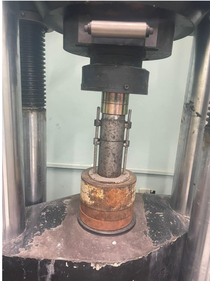
Figura 16: Moldagem da mistura na prensa.
