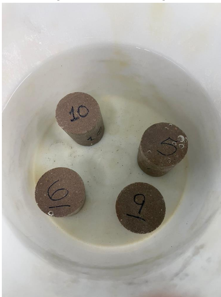
Figura 19: CP's submersos em água.
