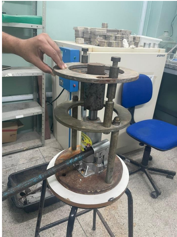
Figura 17: Extração do Corpo de Prova.
