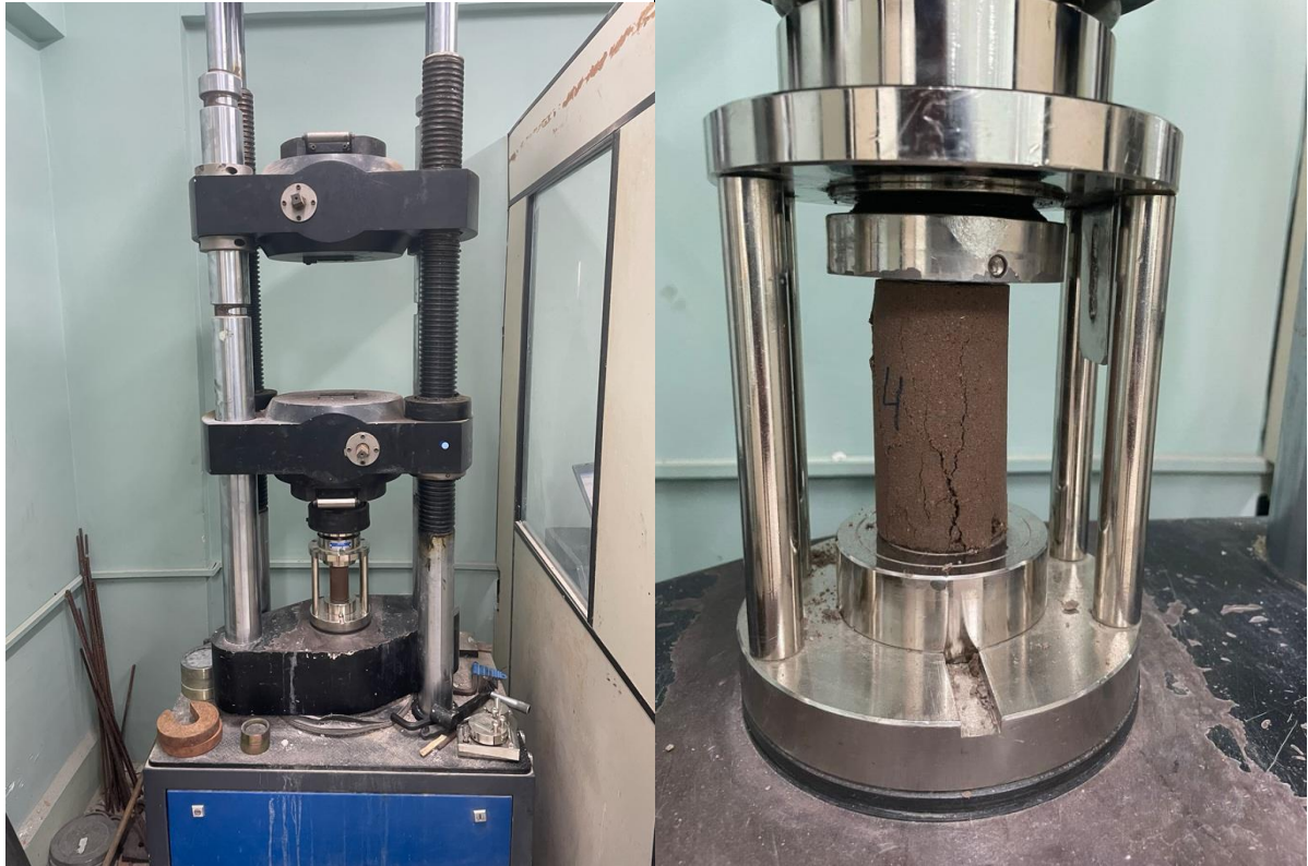
Figura 22: Ruptura dos copos de prova.
