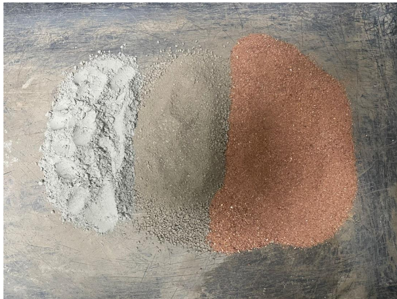
Figura 10: Traço da mistura (cimento, argila e areia).
