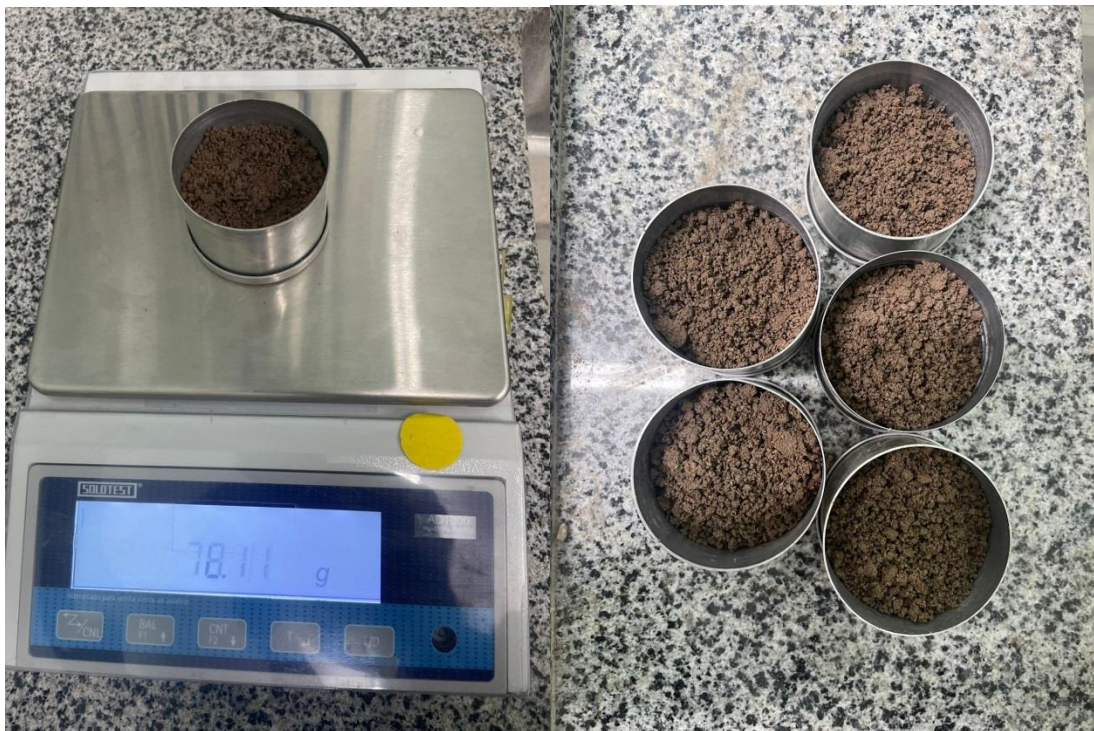
Figura 12: Separação das camadas dos CP's.
