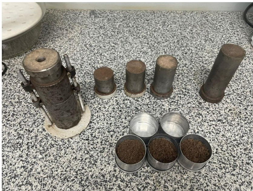
Figura 15: Frações da amostra prontas para o processo de compactação (Segunda fração).
