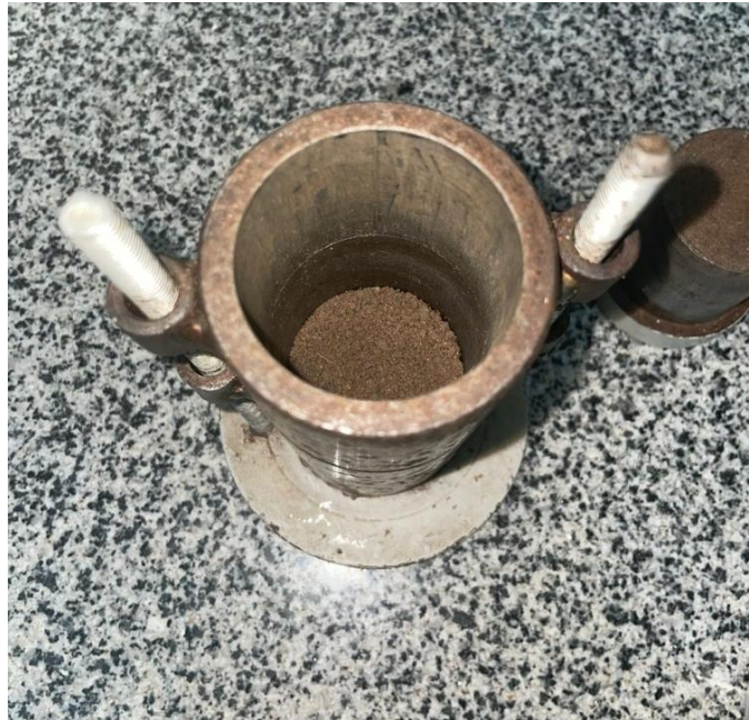
Figura 14: Porção da amostra dentro do cilindro de moldagem.
