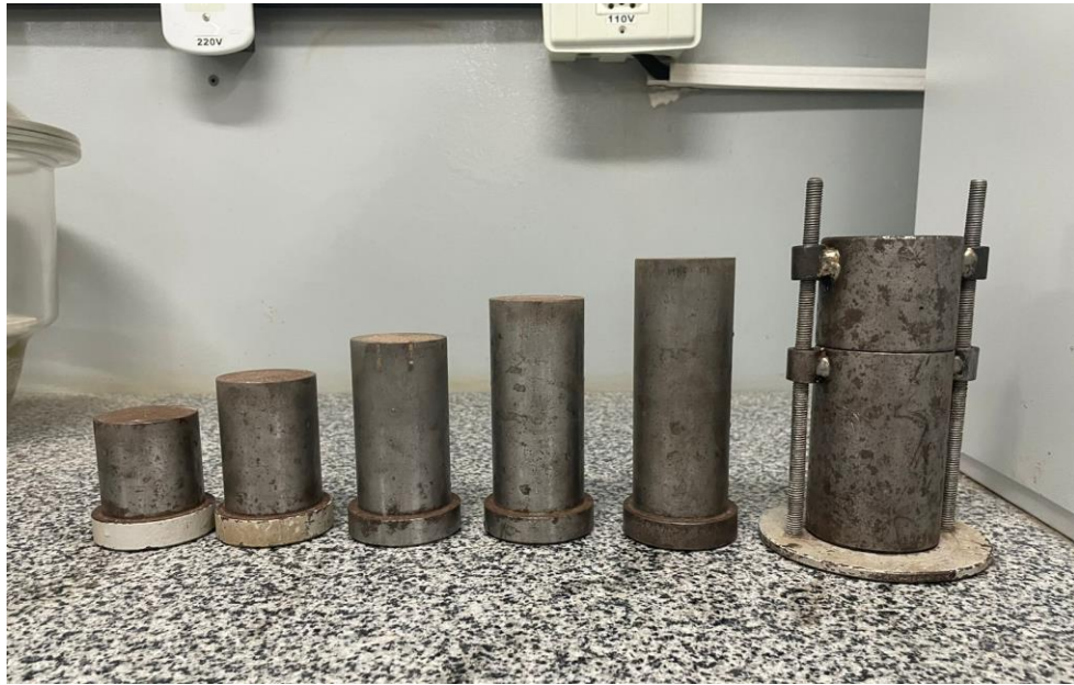
Figura 13: Cilindro e Tarugos de compactação.
