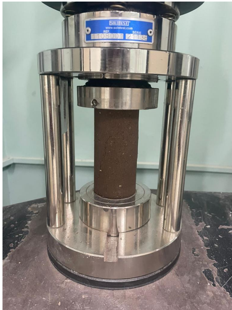
Figura 21: Adaptador para ruptura de solo-cimento.
