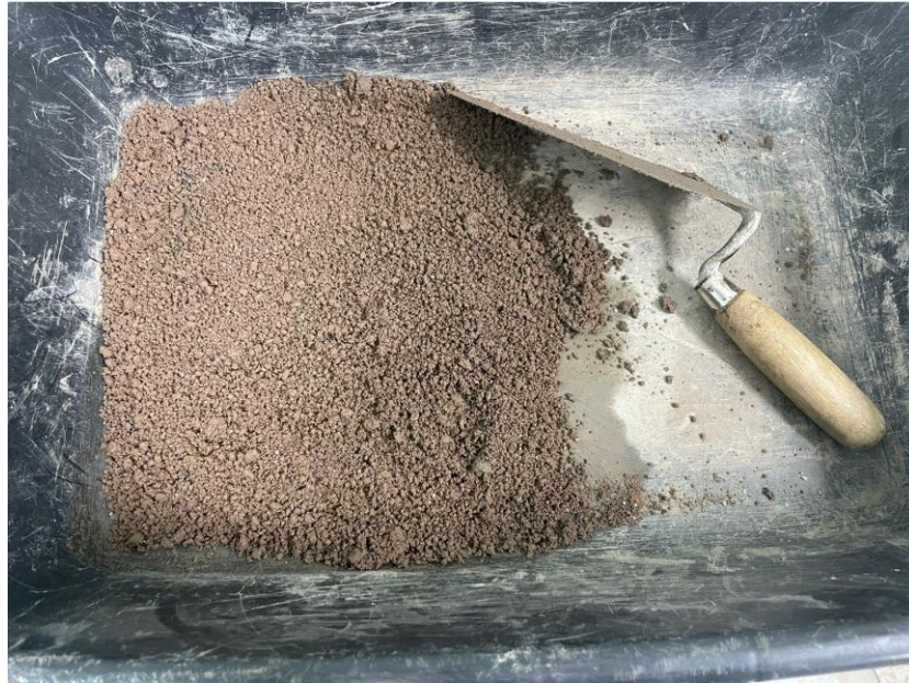
Figura 11: Traço com adição de água e homogeneizado.
