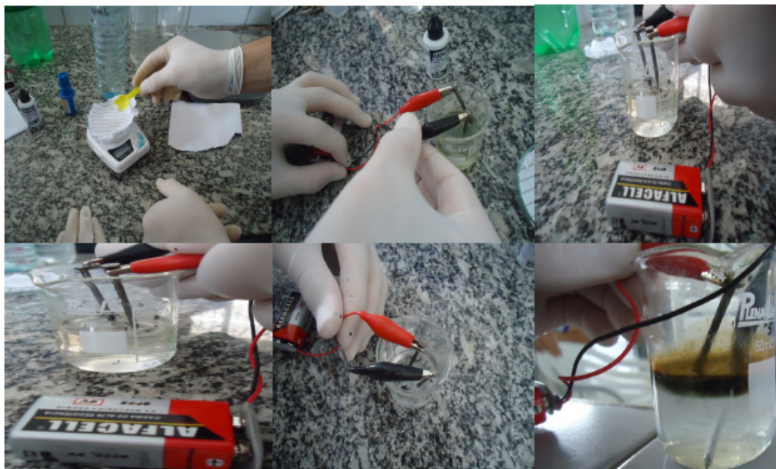
Figura 9. Etapas do processo de remoção da água por eletrofloculação
