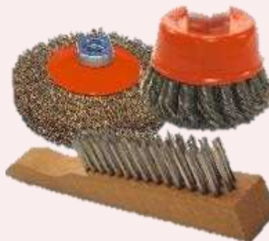
Figura - 19 – Escovas de aço manuais e rotativas
