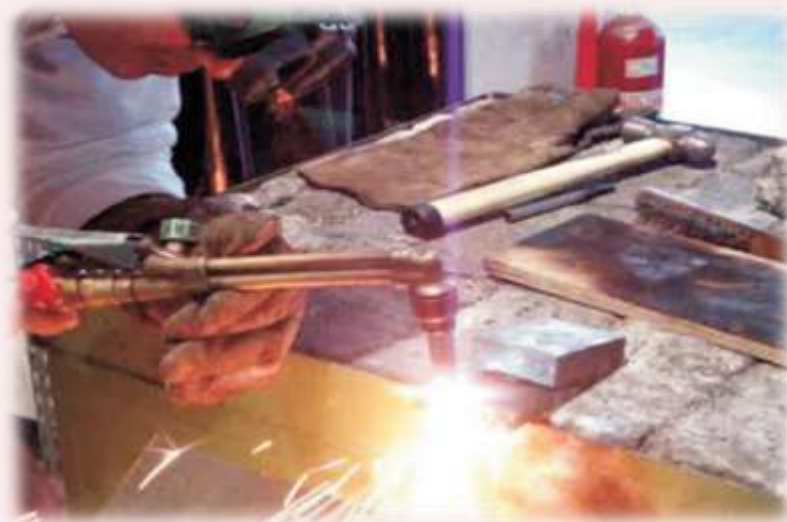
Figura 37 – Execução de um corte térmico com maçarico
