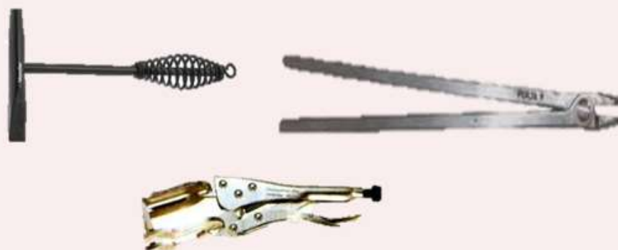
Figura 20 – Acessórios empregados nas atividades de soldagem
