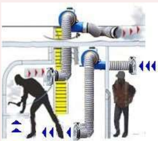
Figuras 13 – Ambientes confinados com sistemas de exaustão forçada
