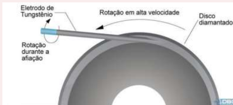
Figura 29 – Afição da ponta do eletrodo de tungstênio
