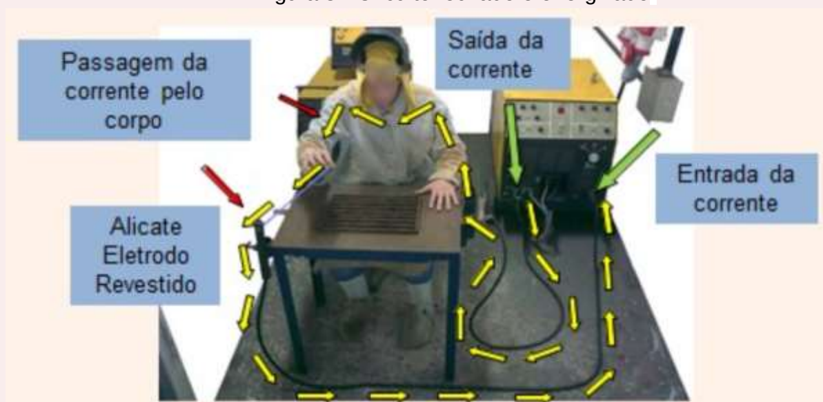
Figura 8 - Circuito fechado e energizado.
