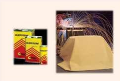
Figura 12 – Materiais inflamáveis e sua proteção
