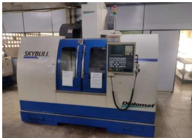
Figura 8 – Centro de usinagem (Comando Numérico Computadorizado)
