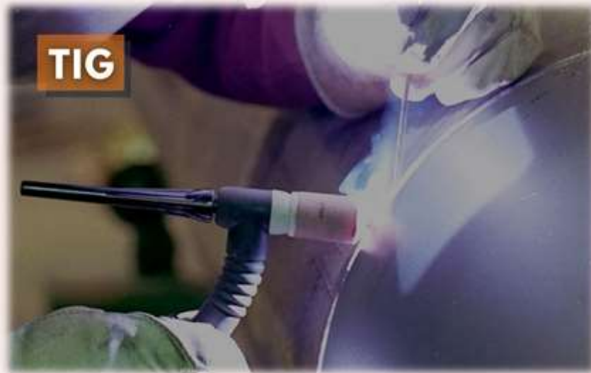
Fig. 25 – Execução da técnica de solda TIG
