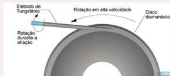
Figura 29 – Afiação da ponta do eletrodo de tungstênio
