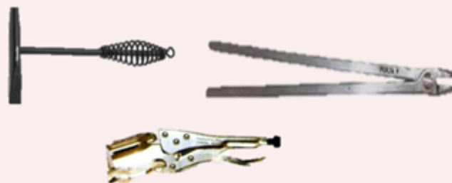
Figura 20 – Acessórios empregados nas atividades de soldagem
