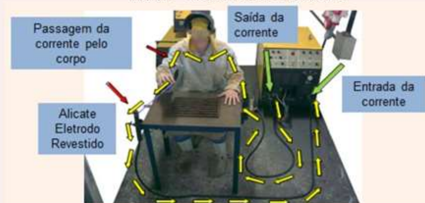
Figura 8 - Circuito fechado e energizado.
