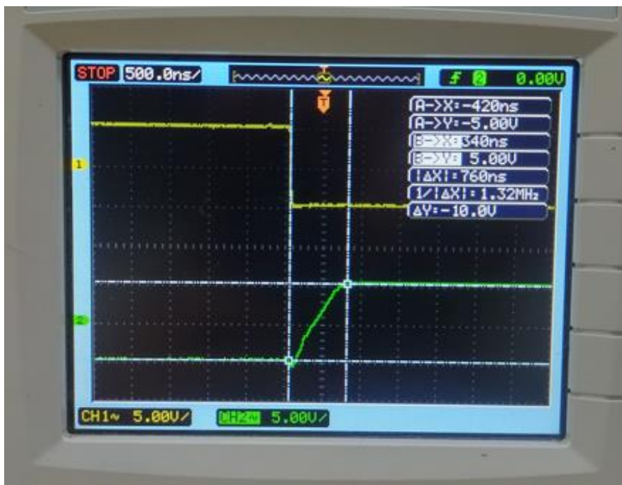
Figura 79 – Gráfico da Resposta para Análise do Slew Rate Prático (TL082C).
