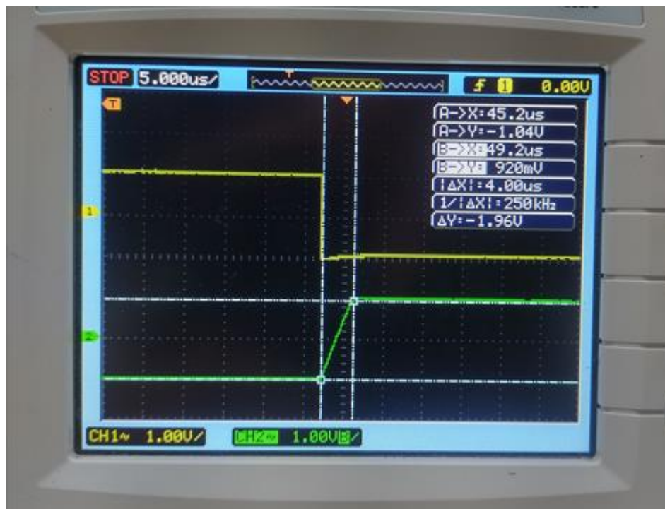
Figura 77 – Gráfico da Resposta para Análise do Slew Rate Prático (741).
