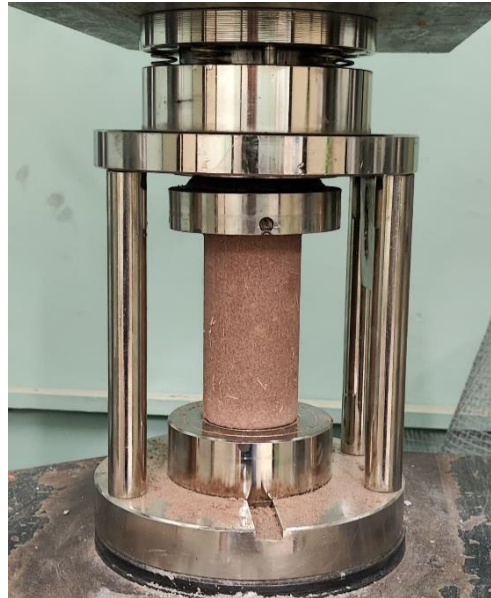
Figura 22: Adaptador para ruptura do corpo de prova.
