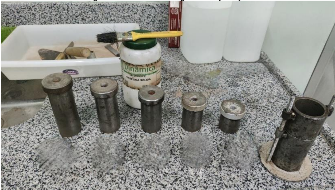
Figura 16: Cilindro e Tarugos de compactação.
