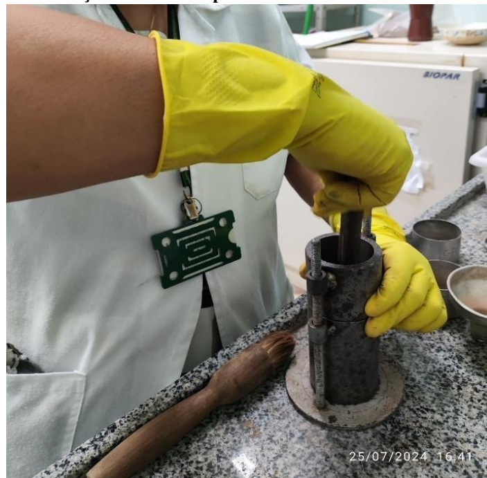
Figura 18: Produção de ranhuras para aumento de aderência entre camadas.
