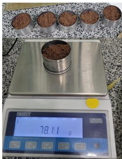
Figura 10 - Separação do material necessário para cada camada do corpo de prova.
