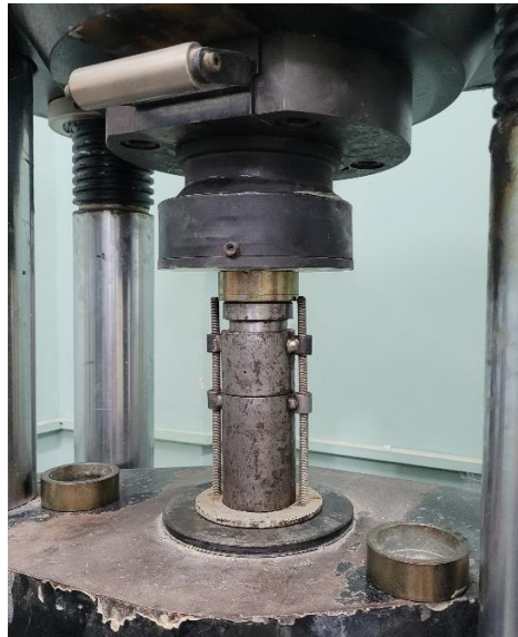
Figura 13 - Moldagem da mistura na prensa.
