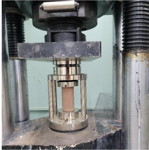
Figura 16 - Corpo de prova pronto para o início do ensaio de compressão simples.
