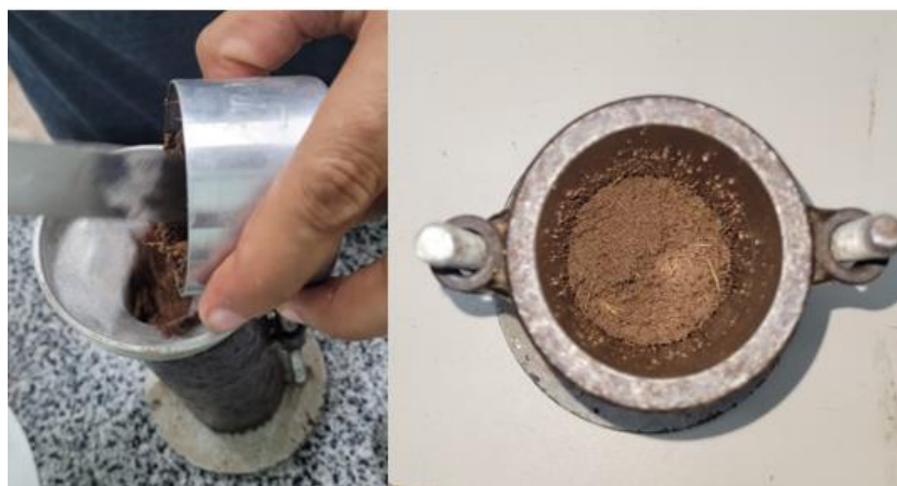
Figura 12 - Compósito sendo inserido no interior do cilindro e amostra dentro do cilindro.
