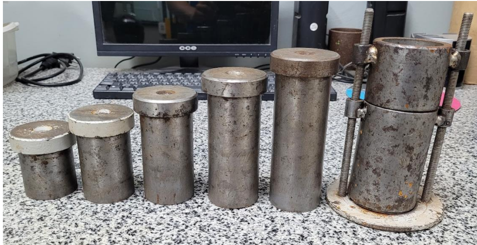
Figura 11 - Tarugos de compactação e cilindro.
