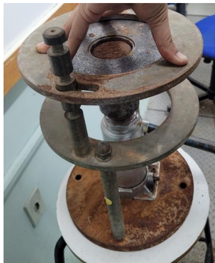
Figura 14 - Corpo de prova sendo removido do extrator.
