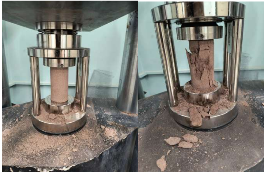
Figura 16: Processo de ruptura dos corpos de prova. Início e final do ensaio.
