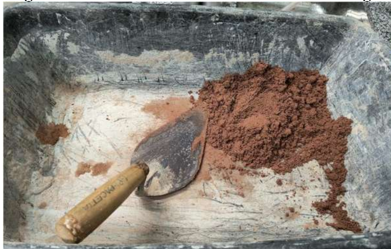
Figura 10: Mistura solo-cimento hidratado e homogeneizado.
