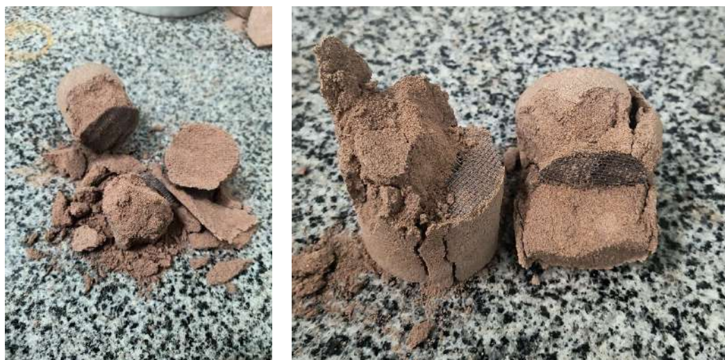
Figura 23: Tipos de ruptura dos corpos de prova com quatro telas.
