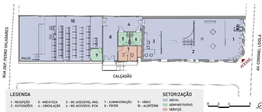
Figura 16 - Planta baixa após a restauração e ampliação.
