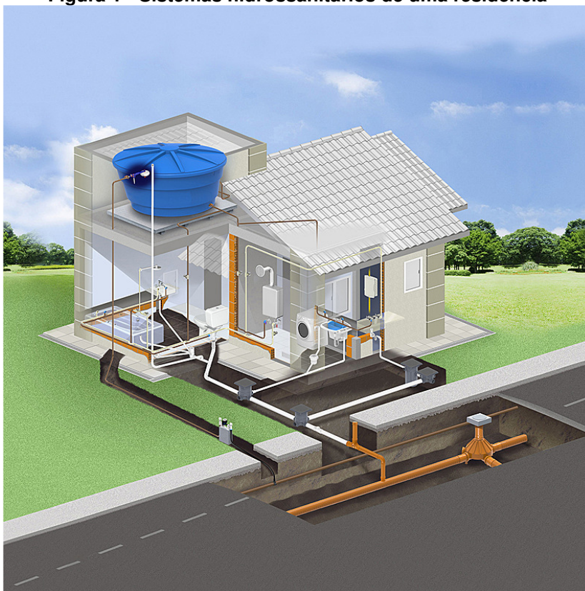
Figura 1 - Sistemas hidrossanitários de uma residência
