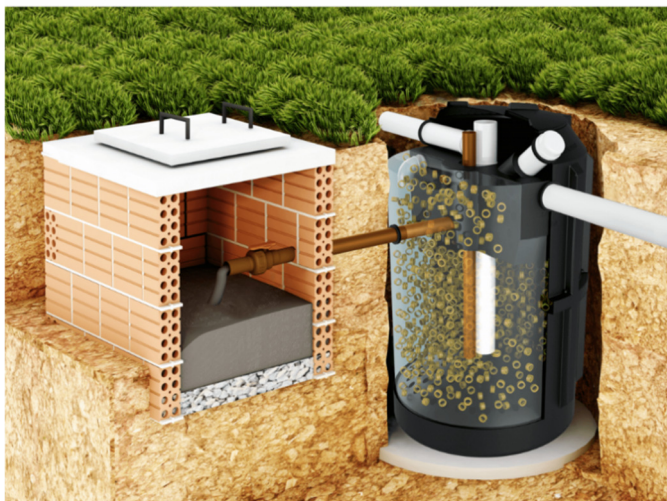
Figura 9 - Esquema de montagem do biodigestor
