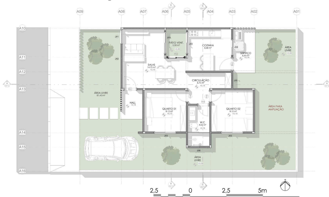
Figura 42 - Planta baixa da Residência Piloto.
