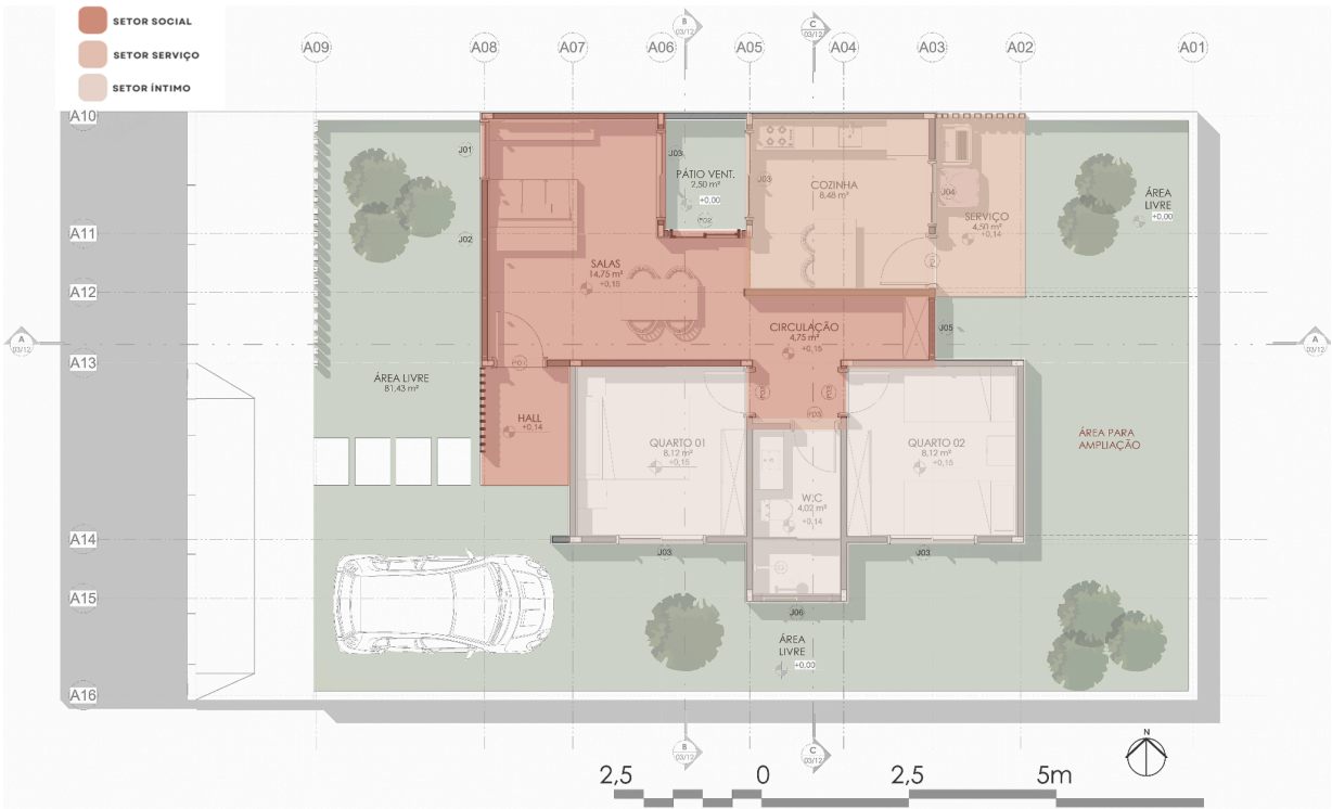
Figura 41 - Setorização dos ambientes do módulo piloto.
