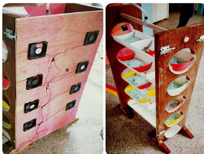
Figura 2 – Protótipo da torre de resfriamento vista lateralmente com todos os seus acessórios
