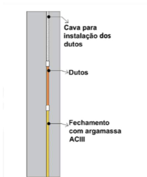
Figura 37: Instalação de dutos nas paredes com Painei Leve Modular.
