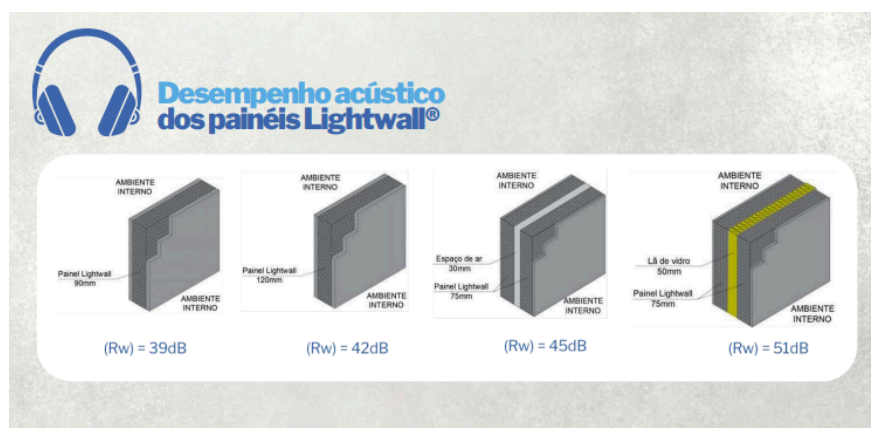
Figura 36: Desempenho acústico dos painéis Lightwall .
