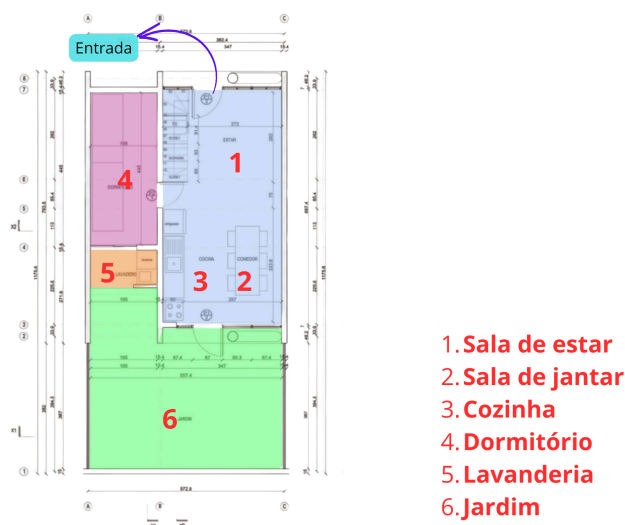
Figura 24: Planta Baixa Pavimento Térreo.
