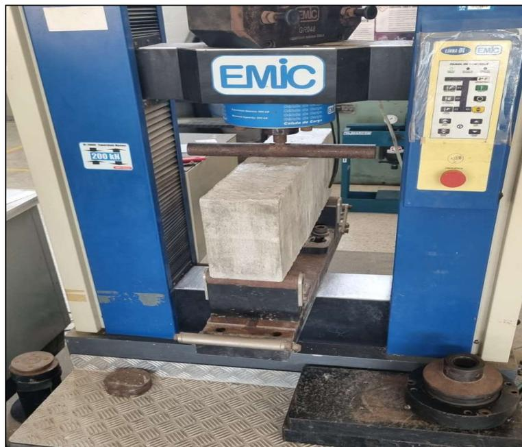
Figura 14. Ensaio de Flexão a três pontos
