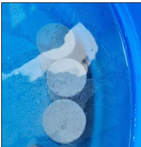
Figura 10. Processo de cura dos corpos de prova cilíndrico.
