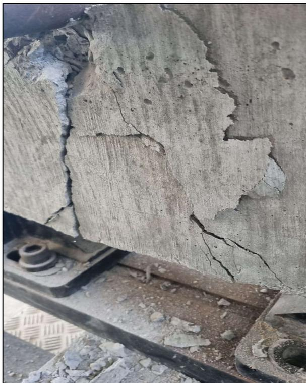
Figura 16. Ruptura do corpo de prova
