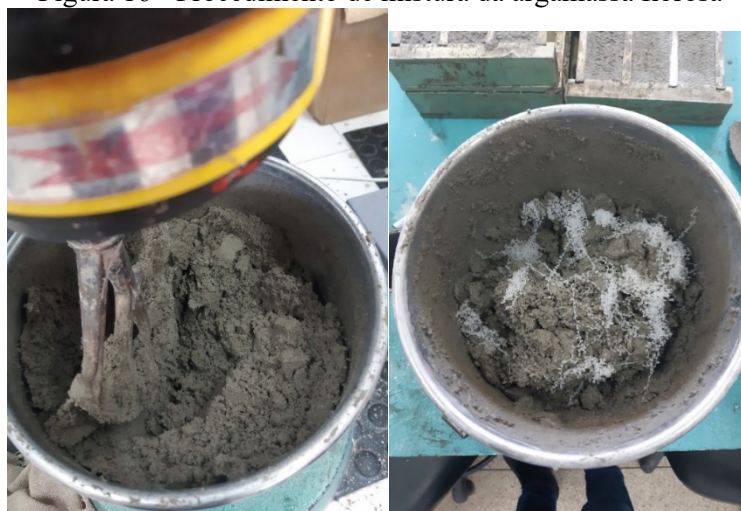
Figura 16 - Procedimento de mistura da argamassa fibrosa
