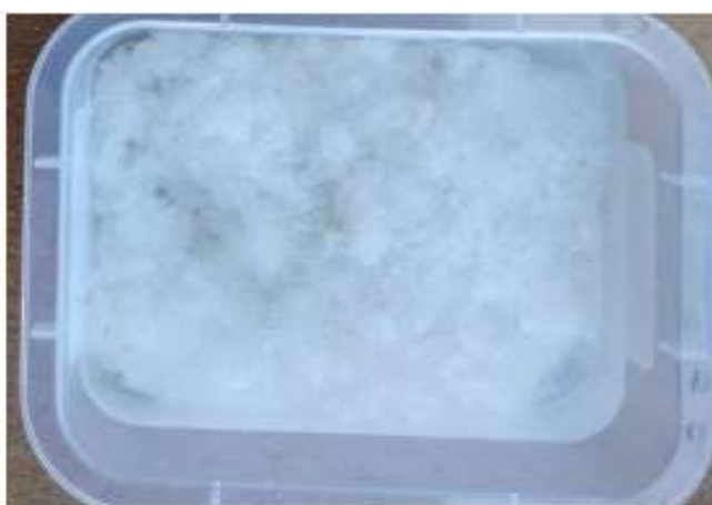
Figura 7 - Fibras à base de poliéster e elastano em processo de hidratação (Santos, 2021).
