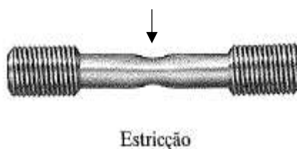
Figura 14 - Exemplo de estrição em barra de aço (HIBBELER, 2010)
