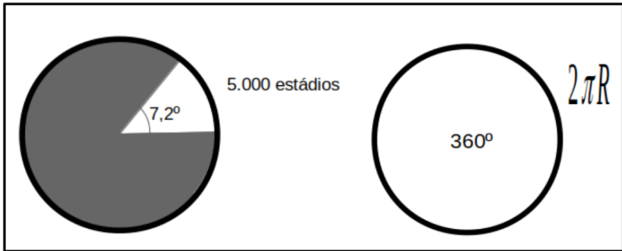
Figura 10: Proporcionalidade entre a abertura angular e o comprimento de arco. À esquerda, tem-se que o ângulo de 7,2^\circ está para a distância de 5.000 estádios. À direita, nota-se que um ângulo de uma volta ( 360^\circ ) é proporcional ao comprimento da circunferência 2\pi R .
