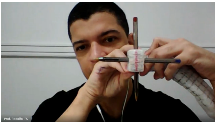
Figura 2 – Exemplo de uso de material flexível como modelo de viga.
