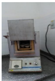
Figura 9: Mufla usada na determinação das cinzas.
