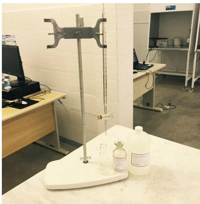
Figura 13: Alguns materiais usados na determinação da acidez volátil: bureta, erlenmeyer, solução indicadora e solução de NaOH.
