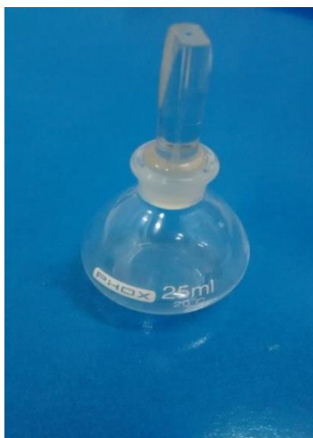
Figura 12: Picnômetro – vidraria usada na determinação do teor alcoólico após a destilação
