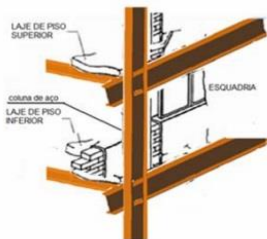
Figura 19 – Trama do vigaamento empregado.
