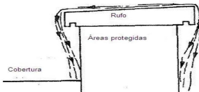
Figura 6: Posicionamento do rufo nas platibandas.
