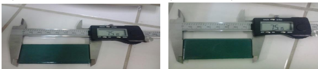
Figura 11: Amostra 3 antes do ensaio e depois do ensaio pelo método de fervura
