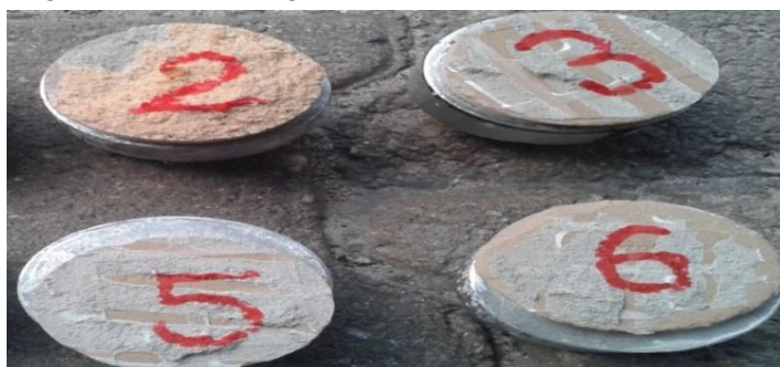
Figura 24: Amostragem de 4 CP's retirados da fachada
