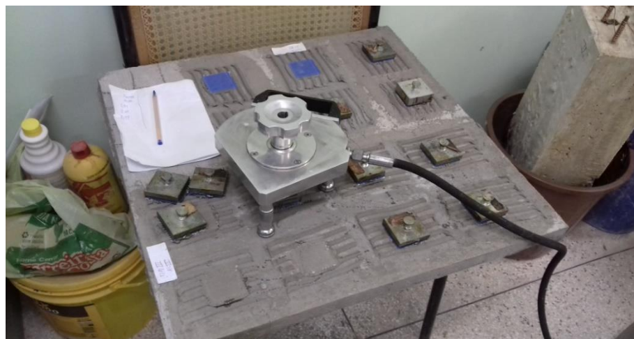
Fotografia 8: Ensaio de resistência de aderência à tração das argamassas colantes.
