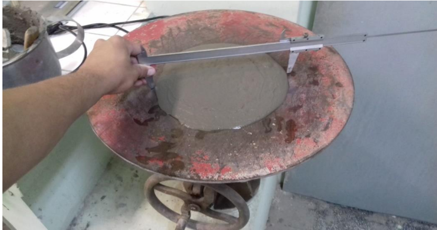
Fotografia 2: Ensaio de mesa de consistência (flow-table).
