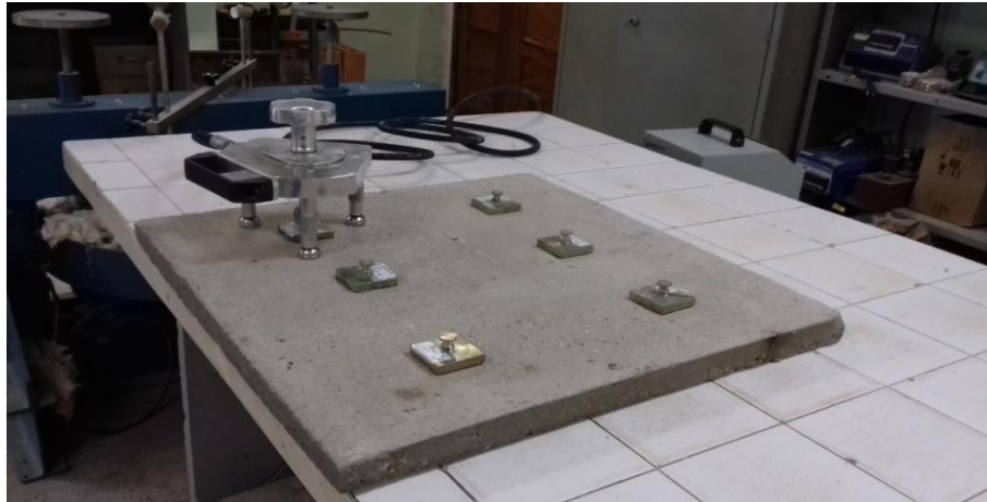
Fotografia 5: Ensaio de resistência à aderência no substrato padrão.
