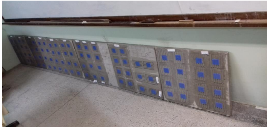
Fotografia 7: Argamassa em cura nas condições ambientais do laboratório.
