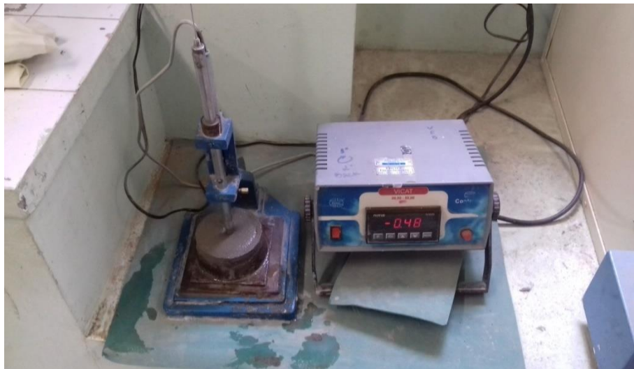
Fotografia 3: Ensaio de consistência pela sonda Tetmajer (adaptado dos cimentos).
