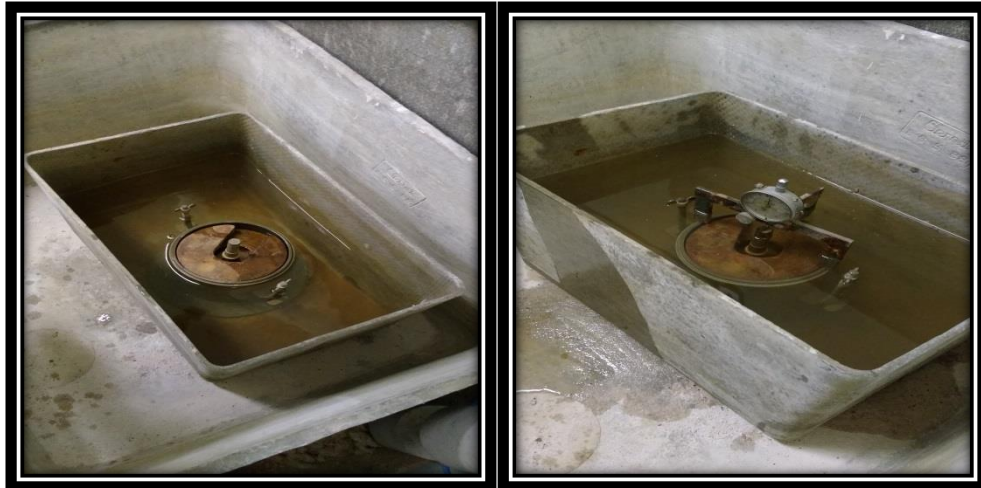
Figura 57 - Ensaio de expansão / retração.
