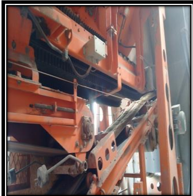
Figura 30 - Esteiras que transportam os agregados.
