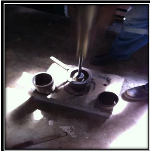
Figura 23 - Compactação dos blocos.
