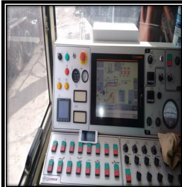
Figura 29 - Dosagem volumétrica controlada por computador.
