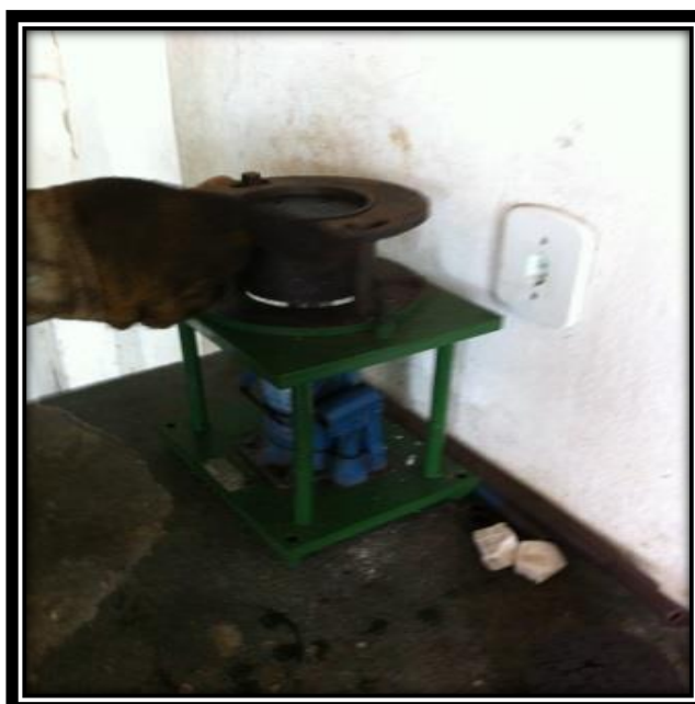
Figura 25 - Desmolde do corpo de prova.
