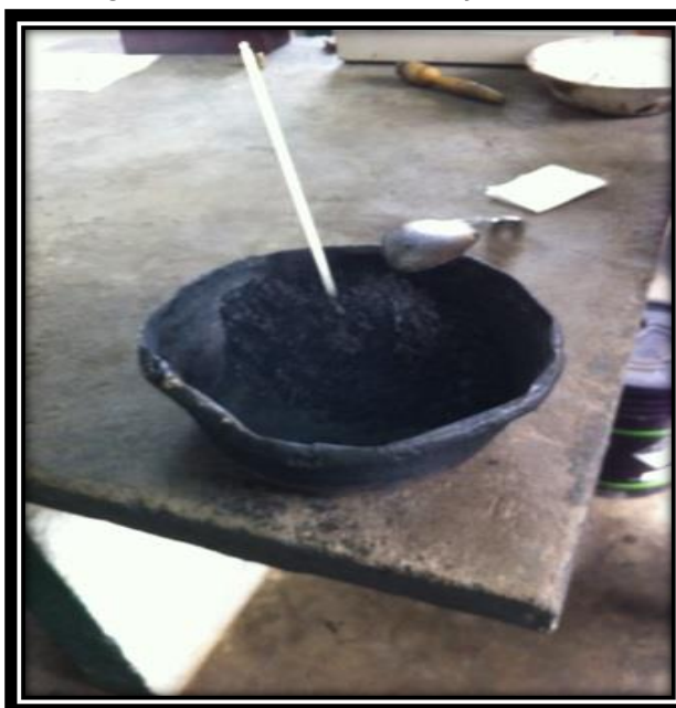
Figura 21 - Mistura com adição do CAP.
