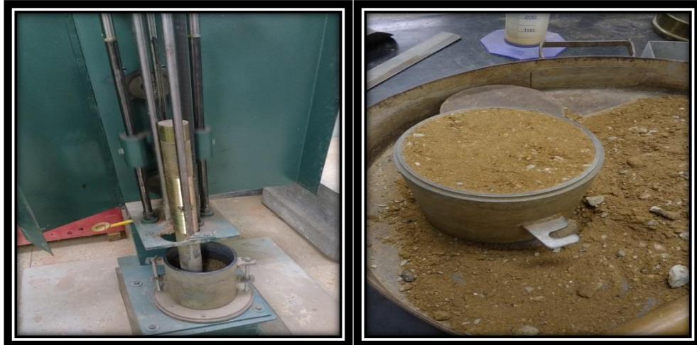
Figura 56 - Ensaio de compactação.
