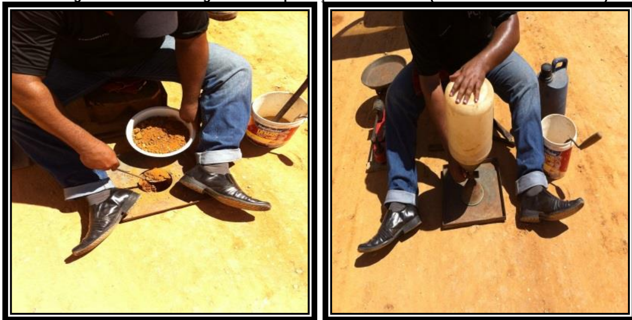
Figura 37 - Ensaio do grau de compactação da sub-base (Ensaio do Frasco de Areia).
