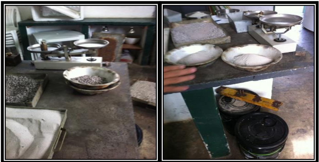
Figura 19 - Pesagem dos agregados.
