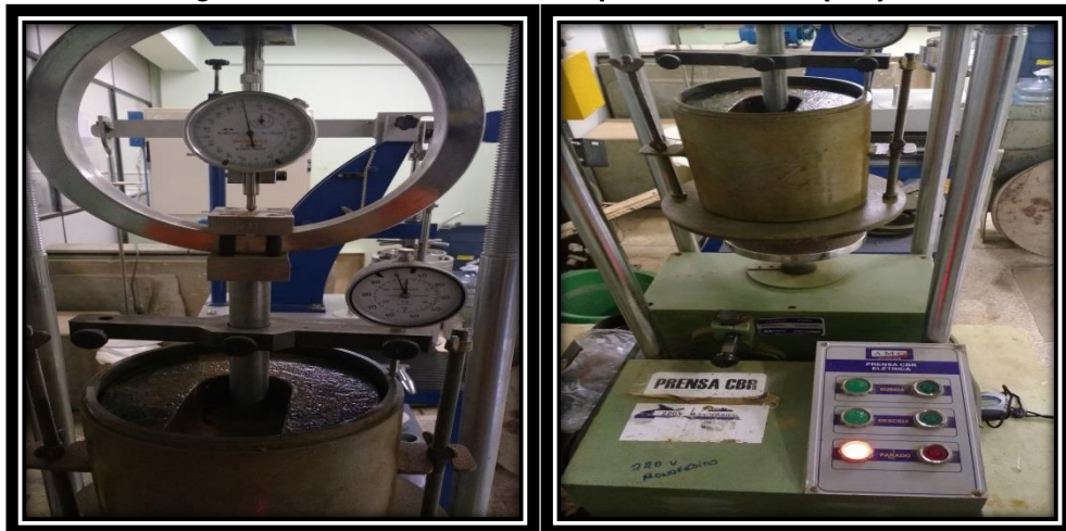
Figura 58 - Ensaio do Índice Suporte Califórnia (ISC).
