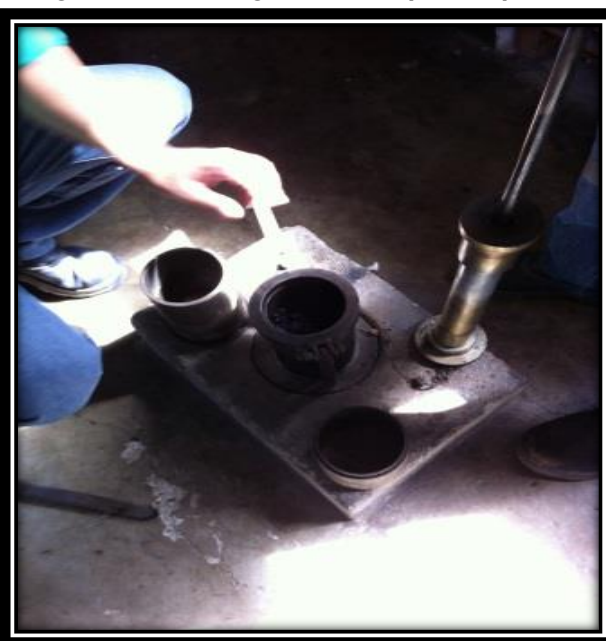
Figura 22 - Moldagem dos corpos de prova.
