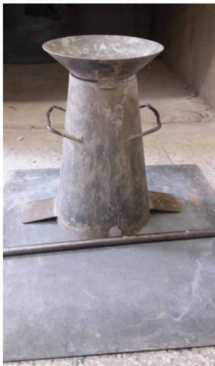
Figura 8 - Aparelhagem do ensaio de abatimento do tronco de cone
