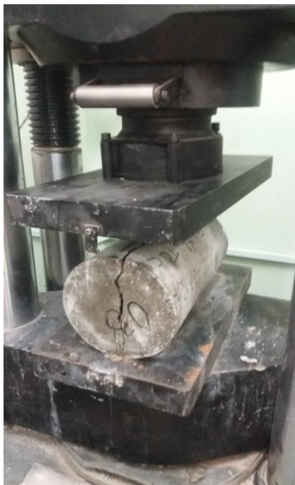
Figura 13 - Ensaio de tração por compressão diametral
