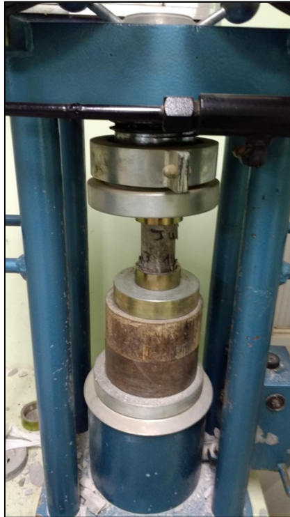
Figura 7 - Realização do ensaio de compressão através da prensa manual
