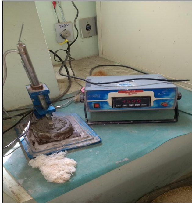
Figura 3 - Realização do ensaio de consistência através da Sonda de Tetmajer
