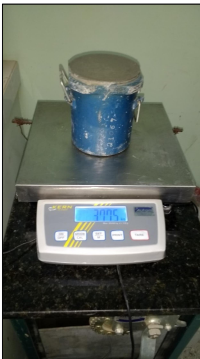
Figura 5 - Pesagem da argamassa para posterior cálculo de densidade de massa
