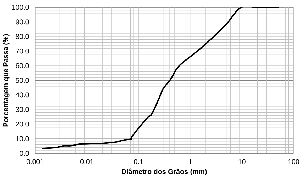
Gráfico 1 – Curva granulométrica do agregado reciclado.
