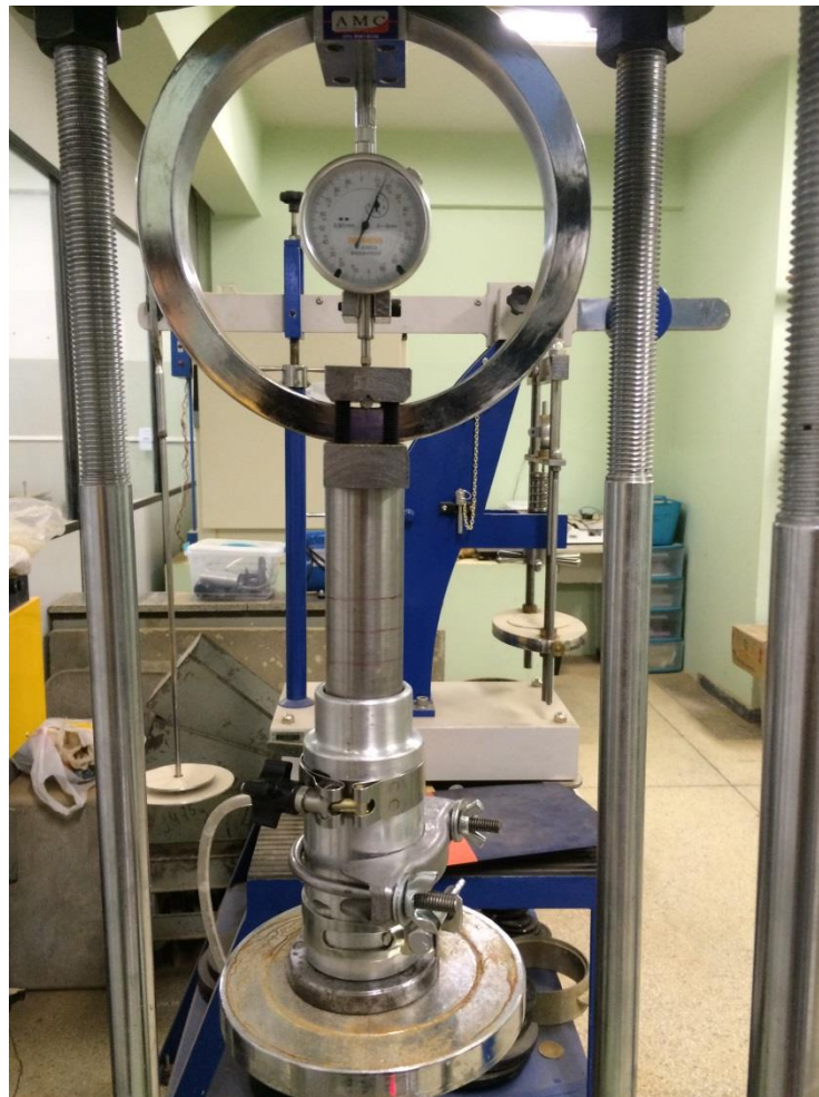
Imagem 11 - Processo de moldagem do corpo de prova na prensa ISC.
