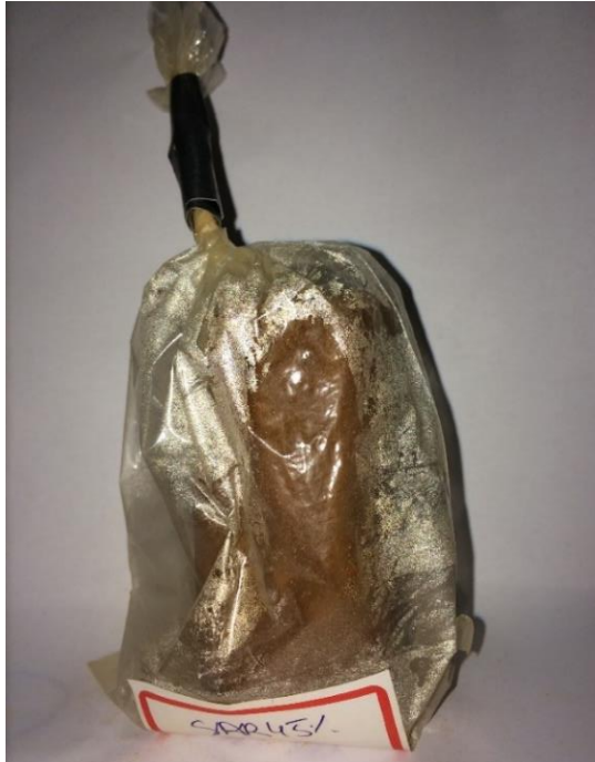
Imagem 9 – Visão geral do corpo de prova em processo de cura.
