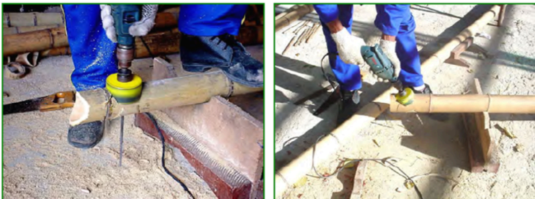
Figura 24 - Corte ortogonal e Corte em 45°. Fonte: Pereira (2001)
