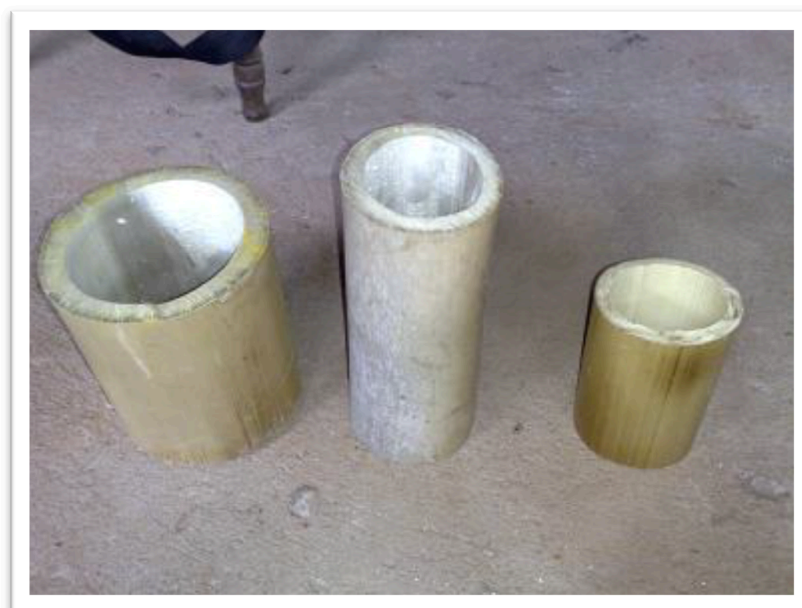
Figura 8 - Corte de colmos de Dendrocalamus Giganteus , Bambusa Vulgares e Phyllostachys Aurea respectivamente nessa ordem. Fonte: GHAVAMI, 1995
