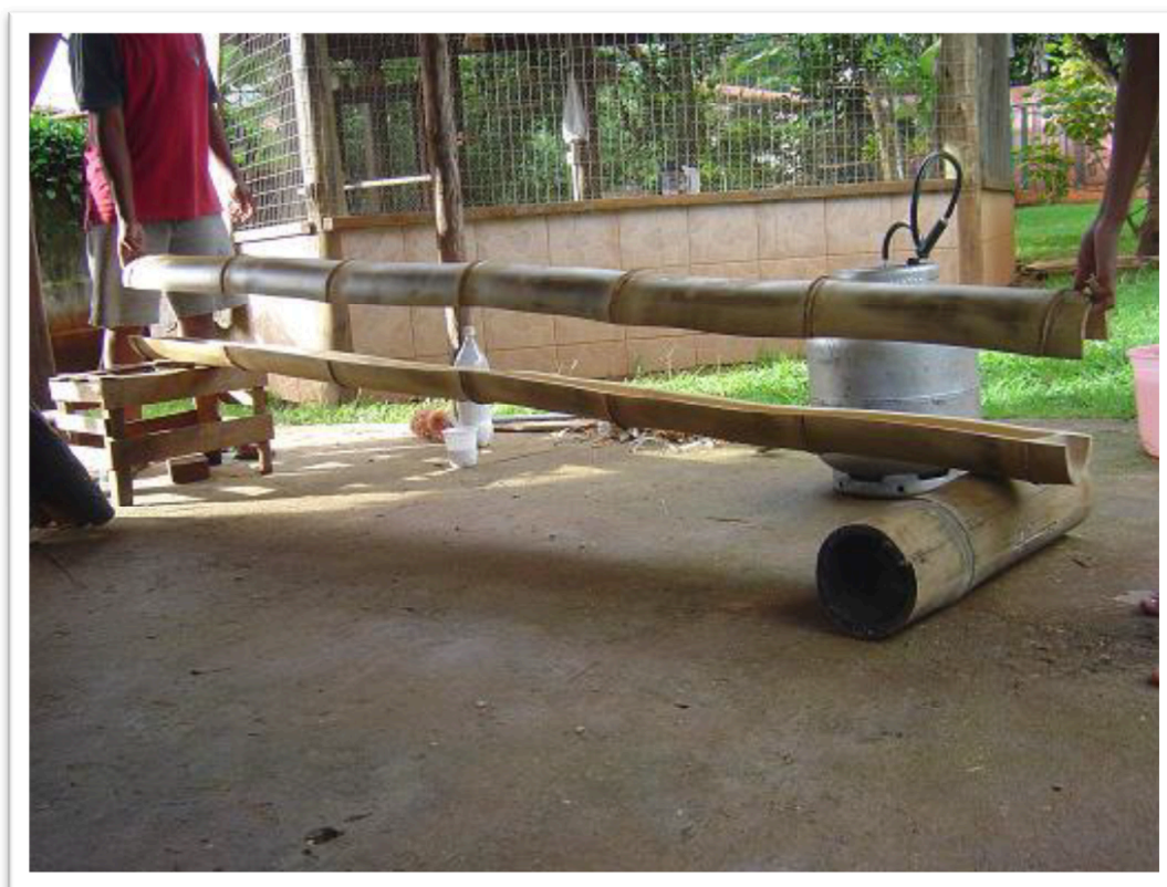
Figura 14 - Corte feito no sentido das fibras com o uso de um facão e martelo. Fonte: Pereira (2001)
