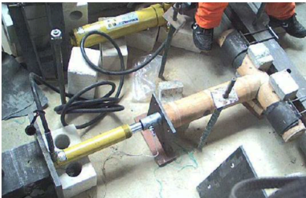
Figura 32 - Teste de compressão na Conexão SV 90°. Fonte: Pereira (2001)
