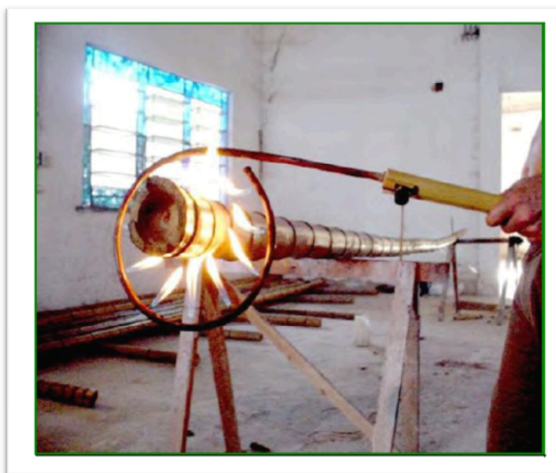
Figura 18 - Queimador de bambu. Fonte: Pereira (2001)
