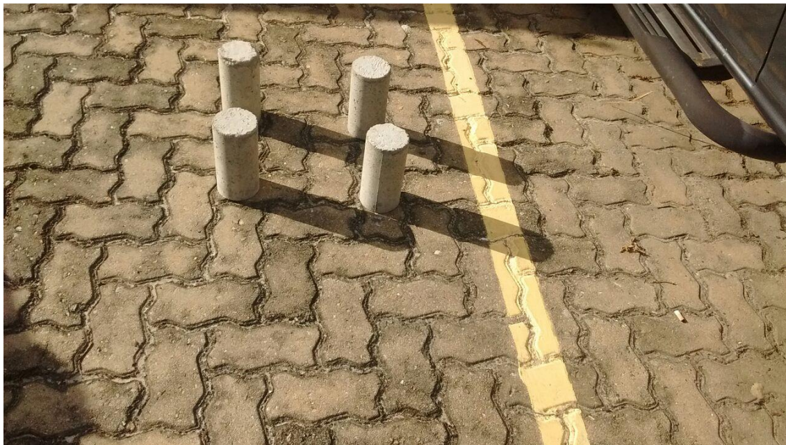
Figura 6: Cura ao ar livre pelo procedimento de molhagem
