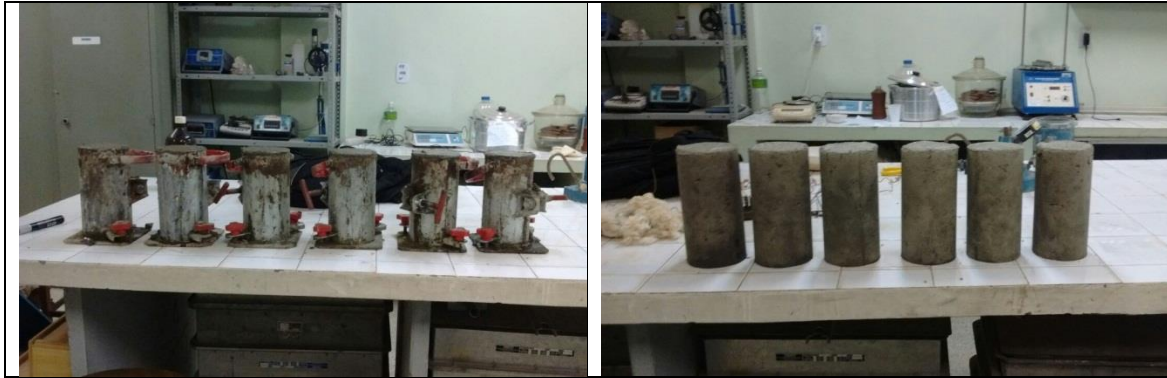
Figura 9: Moldagem e desforma dos corpos de prova cilíndricos de concreto
