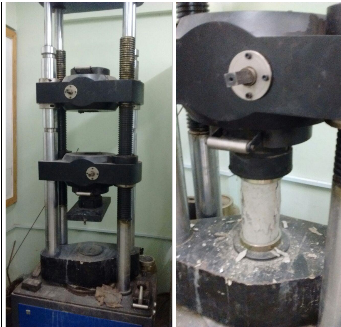
Figura 10: Ensaio de compressão de corpos de prova cilíndricos de concreto
