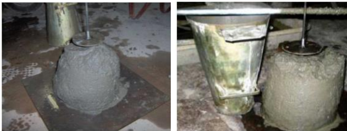
Figura 8: Ensaio do tronco de cone modificado
