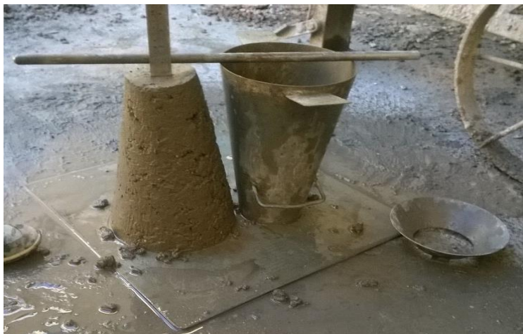
Figura 7: Ensaio de abatimento do tronco de cone
