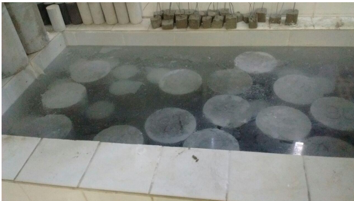
Figura 5: Cura em tanque com água saturada em cal
