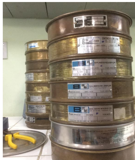
Fotografia 2 - Ensaio de granulometria do agregado miúdo
