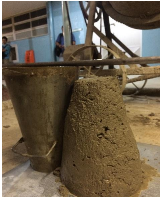
Figura 3 - Abatimento do tronco de cone pelo método IPT
