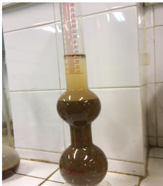
Fotografia 1 - Ensaio de massa específica pelo método de Chapman
