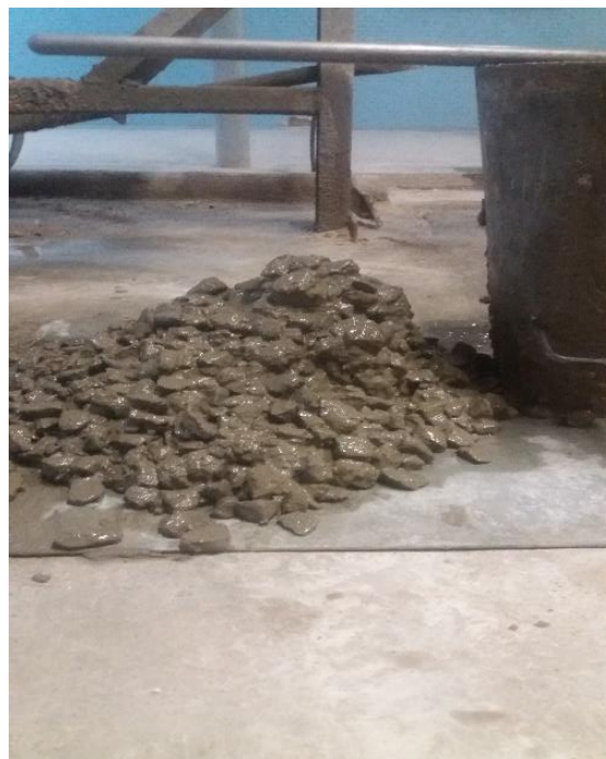
Figura 5 - Abatimento do tronco de cone pelo método ABCP
