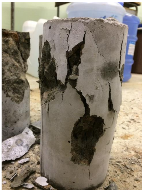
Figura 8 - Rompimento de corpo de prova a compressão
