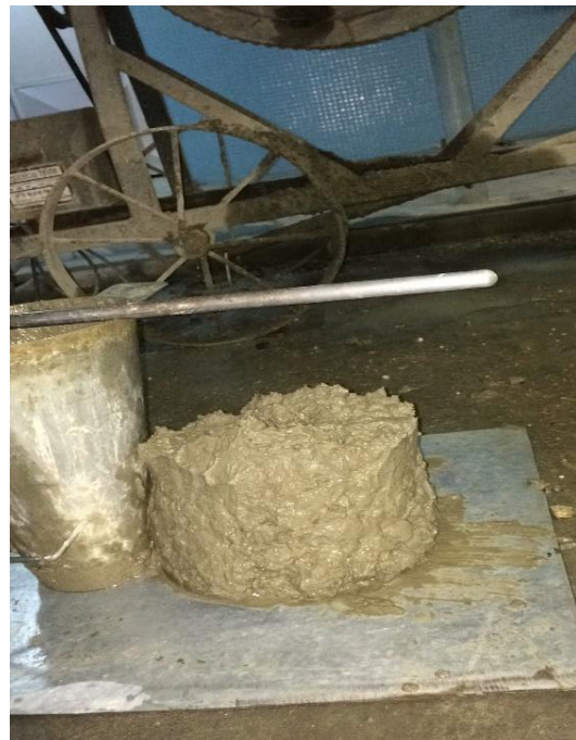
Figura 4 - Abatimento do tronco de cone pelo método INT
