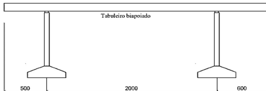
Figura 8 - Esquema estrutural da ponte (unidade: cm).
