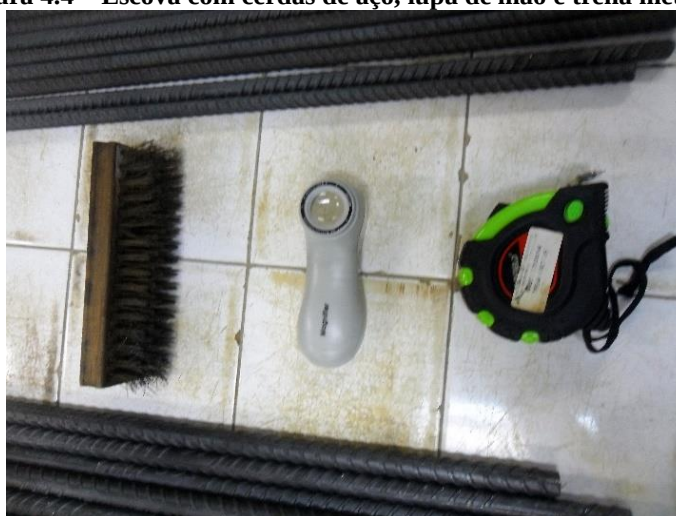
Figura 4.4 – Escova com cerdas de aço, lupa de mão e trena metálica
