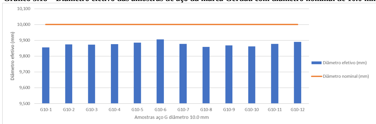
Gráfico 5.18 – Diâmetro efetivo das amostras de aço da marca Gerdau com diâmetro nominal de 10.0 mm
