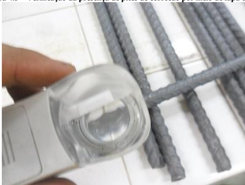
Figura 4.9 – Verificação da presença de pites de corrosão por meio de lupa de mão
