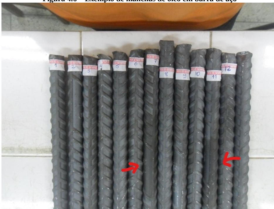
Figura 4.6 – Exemplo de manchas de óleo em barra de aço
