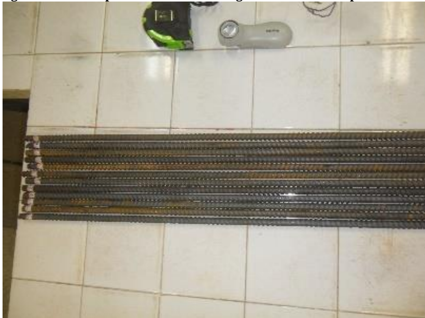
Figura 4.8 – Exemplo de amostras de vergalhões oxidados superficialmente
