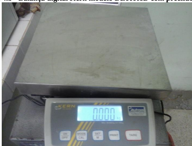
Figura 4.5 - Balança digital Kern modelo DE60K1D com precisão de 0,5g
