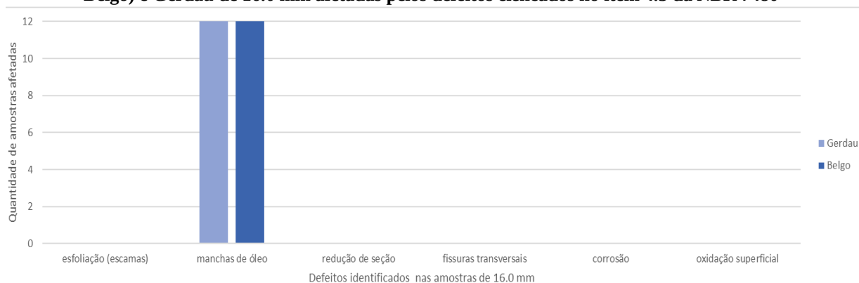
Gráfico 5.5 – Comparativo das quantidades de amostras dos grupos das marcas ArcelorMittal (linha Belgo) e Gerdau de 16.0 mm afetadas pelos defeitos elencados no item 4.3 da NBR 7480
