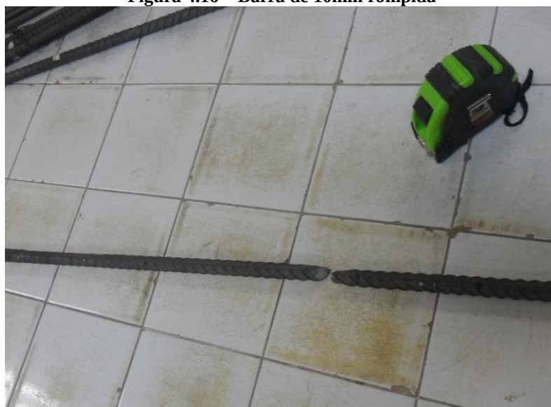
Figura 4.16 – Barra de 10mm rompida
