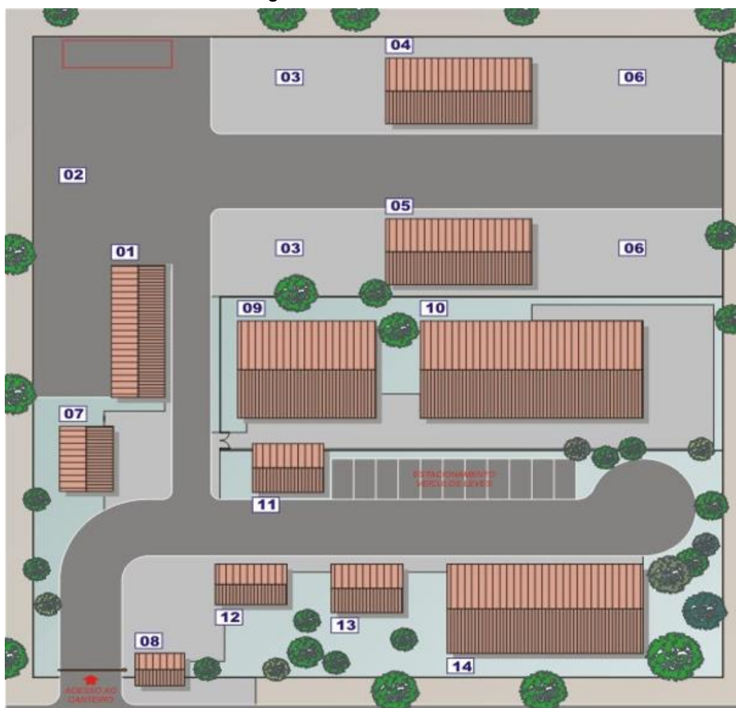
Figura 01 – Canteiro de obra
