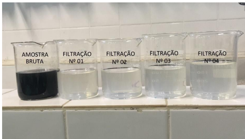
Figura 18 – Evolução da turbidez de uma amostra durante várias passagens consecutivas pelo filtro.
