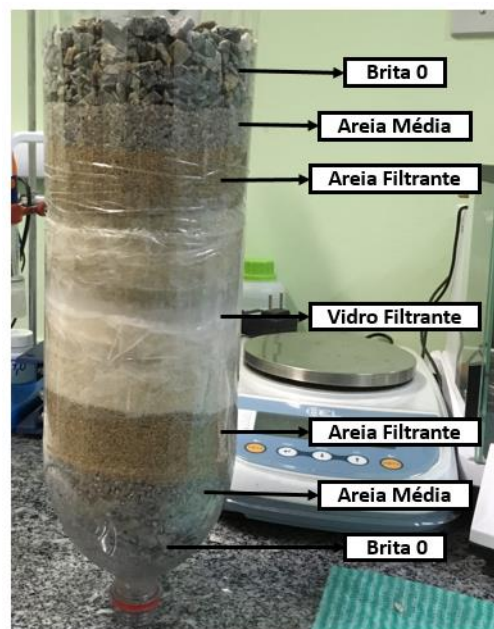
Figura 17 – Modelo de filtro proposto.
