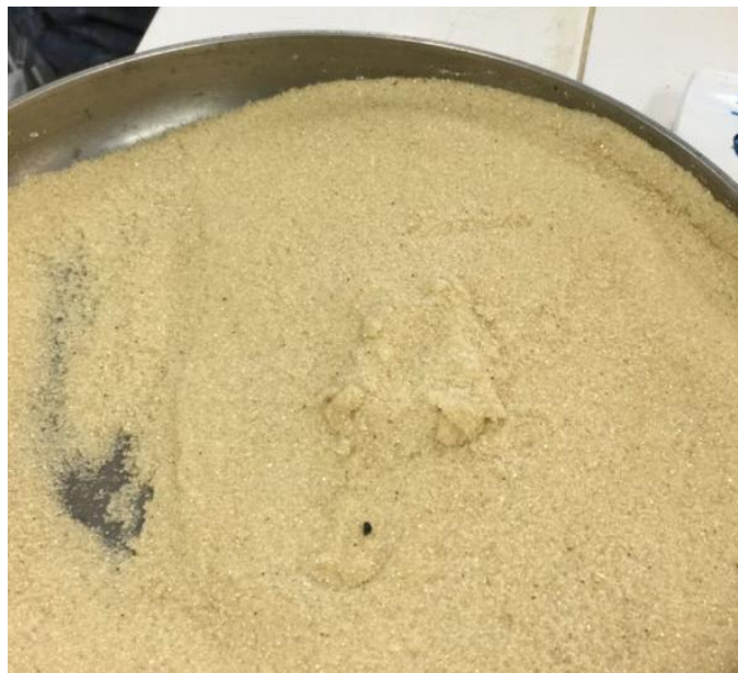
Figura 12 – Grãos de vidro com tamanho efetivo entre 0,60 mm e 0,425 mm.
