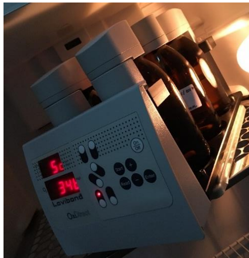
Figura 14 – Leitor de DBO modelo BOD-OxiDirect na incubadora.
