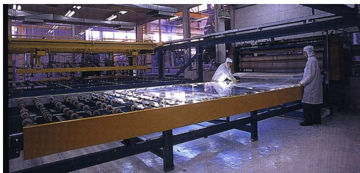
Figura 2.11 - Colocação do PVB para a fabricação do vidro laminado
