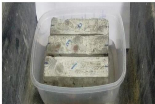
Figura 60: Barra de concreto para medida de expansão para ensaio de durabilidade
