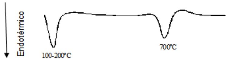
Figura 8: Análise térmica diferencial de uma argila montmorilonitica (Mackenzie, 1959).
