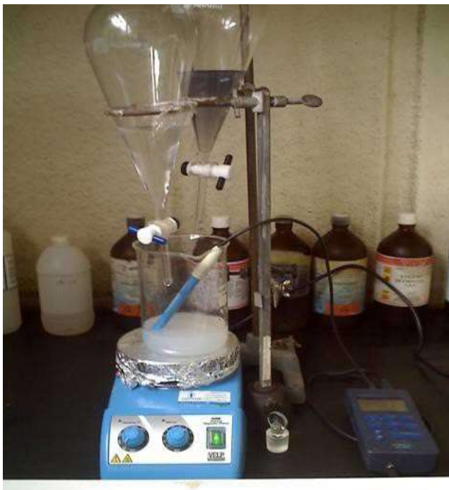
Figura 10 – Aparato utilizado na reação de precipitação da HAP e do \beta -TCP.
